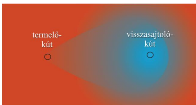
9. ábra: Hűlési zóna kialakulása a termelő kút és a visszasajtoló kút között
