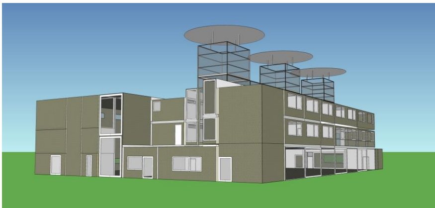
19. ábra: Munkaközi kivitei terv szimulációs multiklimazóna modellje (szoftver: IDA ICE 4.0 - 4.5)
