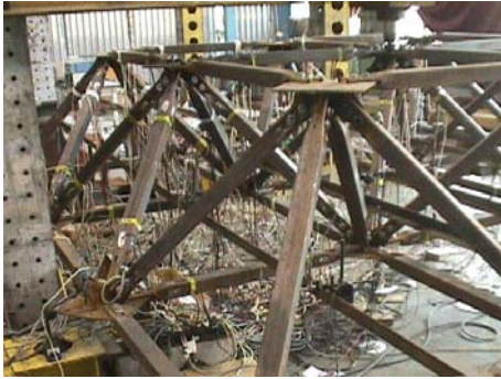
A vizsgált térrácsos tetőszerkezeti szegmens és az első kísérletnél kialakuló lehajlások
