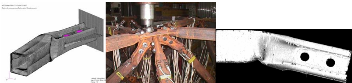
A kis külpontosságú nyomás numerikus eredménye, a teljes léptékű kísérlet tönkremeneteli állapota és a rúdvég 3D-s lézer szkenneres modellje
