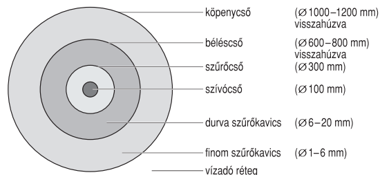
A csőkút szerkezete kétrétegű kavicslással
