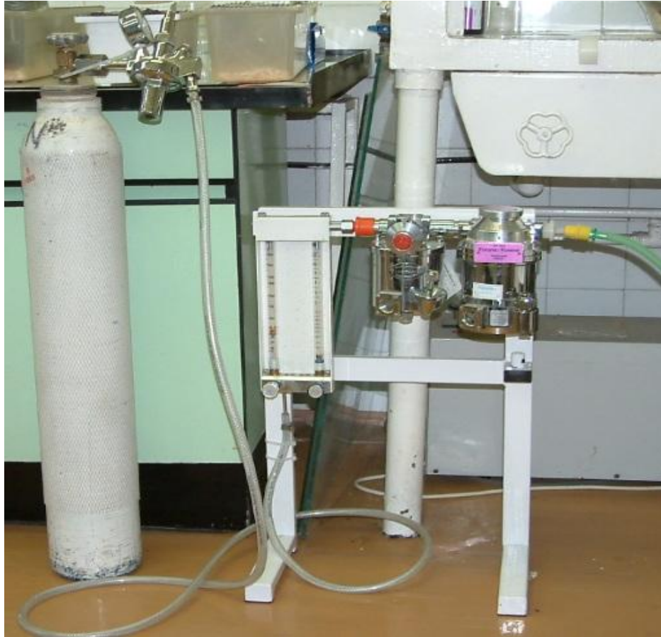
5. ábra Kisállatok és rágeszélők altatásához használt „félíg nyílt” rendszerű altatógép rotaméterrel, oxigén-palackkal és párologtatókkal
