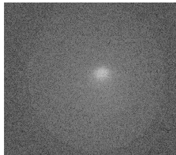
48. ábra Foszforenyő kép közvetlen Marx-generátoros gerjesztéssel létrehozott lézer-szerű sugárzásról.
