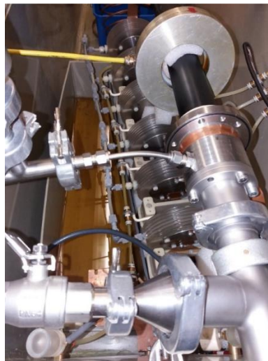
44. ábra Közvetlen Marx generátoros gerjesztés megvalósított kísérleti elrendezése
