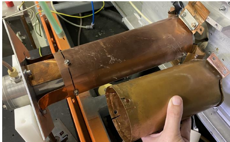
84. ábra Beépített 35 cm hosszúságú, mellette a rövidebb (22 cm) kapillárisokhoz készített koaxiális földelés.
