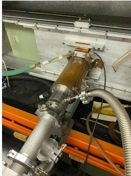
59. ábra Lézerső koaxiális földeléssel.
