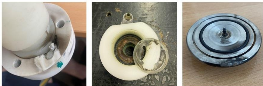
62. ábra Nagyfeszültségű átütések okozta meghibásodások.
