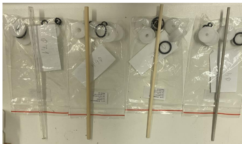
72. ábra Kísérlethez előkészített 22 cm hosszúságú, különböző belső átmérőjű és anyagú kapillárisok a hozzájuk tartozó illesztékekkel.
