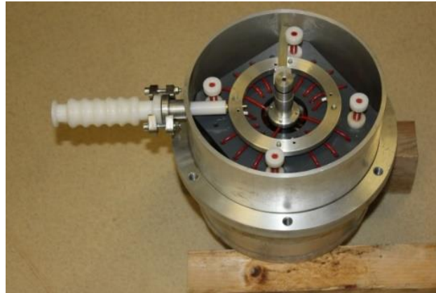
28. ábra Impulzustranzformátor vasmag és tekercek.
