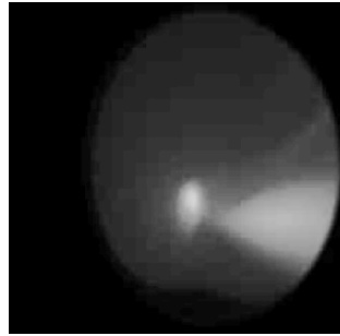
36. ábra Impulzus transzformátor tápegységgel létrehozott kapilláris kisülés erős spontán sugárzása.
