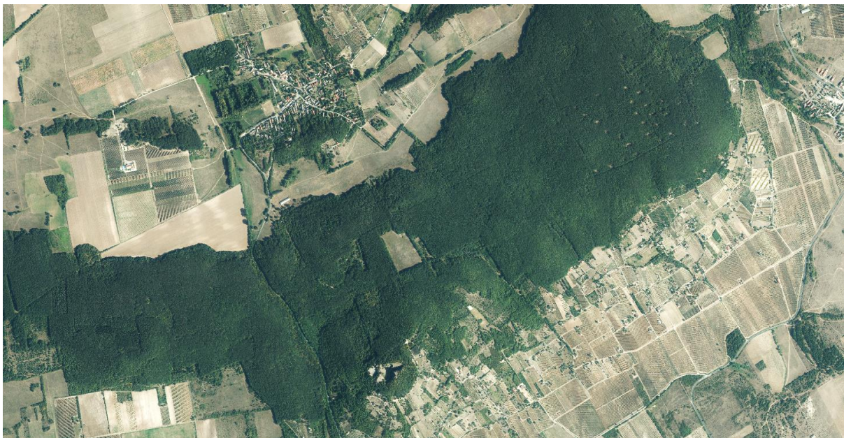
33. ábra. Moiré–jelenség újramintavételezett légifelvételen. A bal alsó sarok EOY koordinátája 541 555 m, 172 376 m (Lechner Tudásközpont, 2012).
