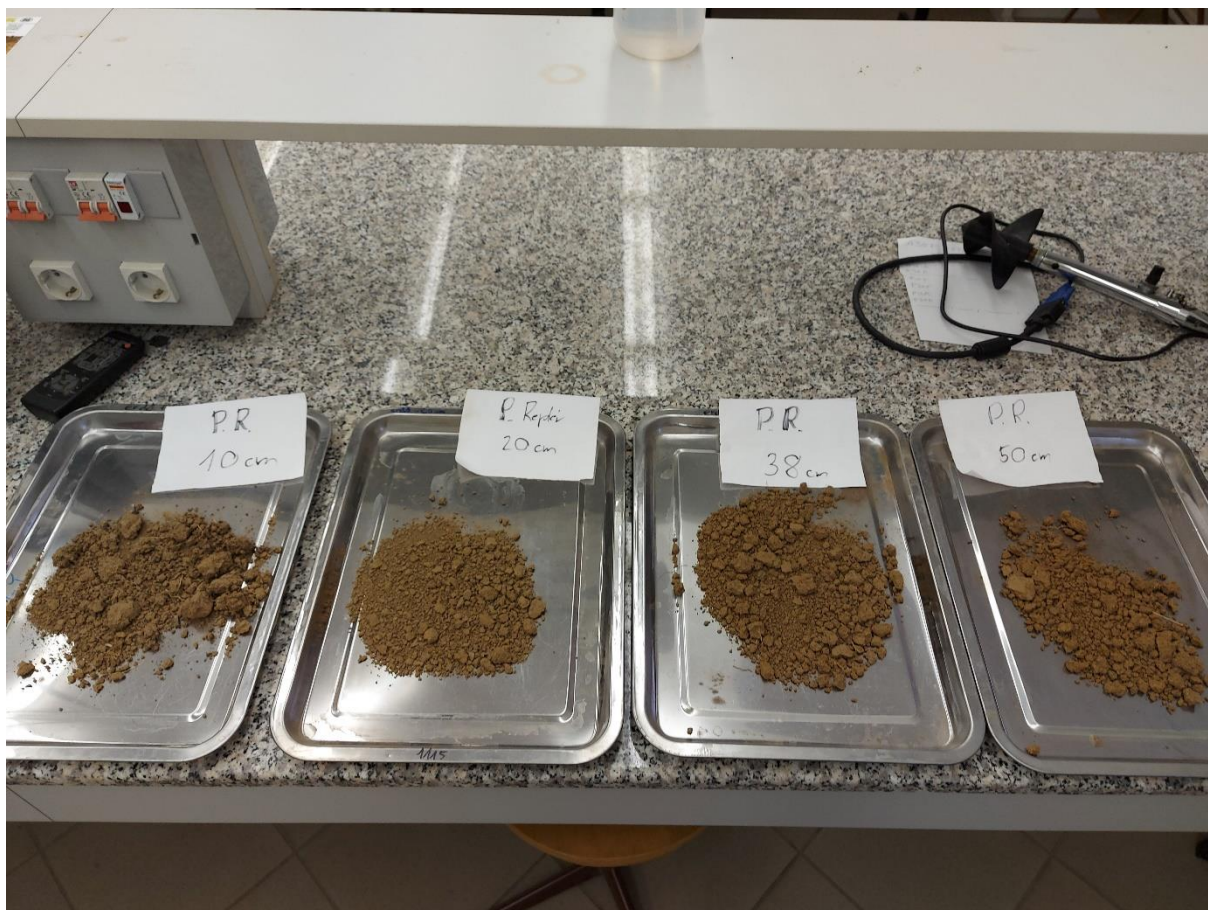
4.31. ábra. A mintavételezés során, különböző mélységű talajrétegekből gyűjtött talajminták előkészítése laboratóriumi vizsgálatokhoz. A talajminták tálcáján lévő címkék feliratozásának magyarázata: „PR” jelölés a pogányi reptér rövidítése, a megjelölt mélységi adat pedig a mintavételezés helyének mélységét mutatja. (saját felvétel)
