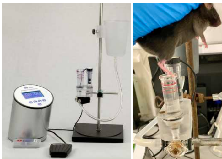
8. ábra: Pletizmométer a láb térfogat mérésére.
