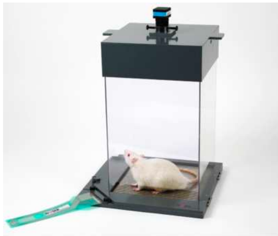
9. ábra: Bioseb készülék a hátsó lábakra való spontán nehézkesedés mérésére.
