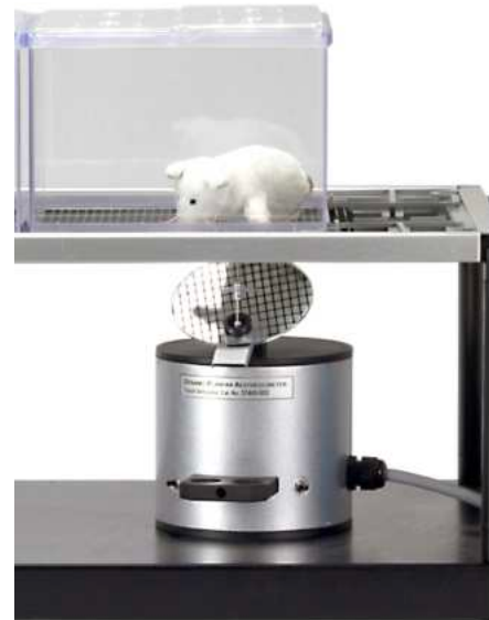
6. ábra: A dinamikus plantáris eszteziométer
