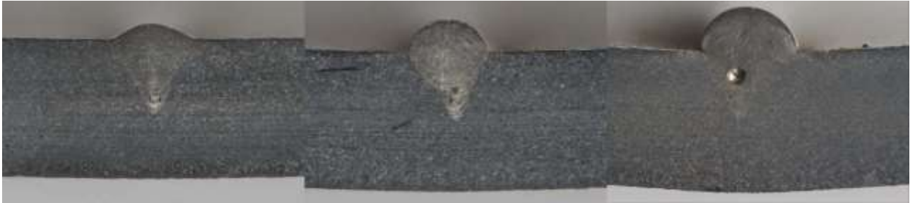
7. ábra: WLAM technológiával készült többsoros varratok keresztmetszetei
