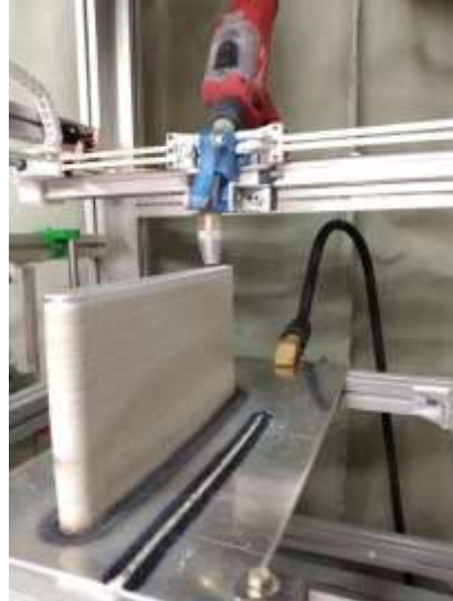
2. ábra: PTE Műszaki és Informatikai Karának kutatócsoportja által fejlesztett 3D fém nyomtató. (Vasvári Gyula Ferenc , 2021)
