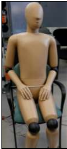
7. ábra: Termikus mérőbábu megjelenése és testrészeinek felülete. Forrás: saját szerkesztés
