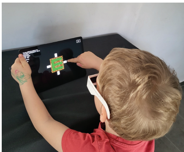
1. ábra | EuvisionTab vizsgálati szituáció. A vizsgálatot elindítva egy 5 éves gyermek akár egyedül is végig tudja csinálni. A tablet kijelzőjén szemüveg nélkül is felismerhető kontrollábra látható, hogy az olvasó nyerjen némi betekintést a vizsgálati helyzetbe (a szülő engedélyével közölve)
