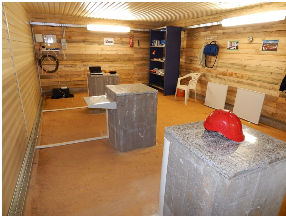
2.4. ábra. A betontömbökön elhelyezett mérési helyek az MGGL-ben (lásd [35] 1. ábra).
