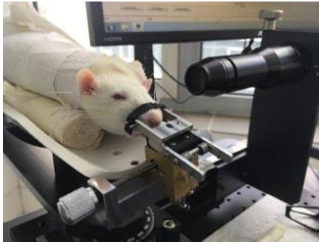
21. ábra: A Leica-Envisu TM R-Series SDOIS típusú OCT készülékkel végzett mérés során a patkány az állattartó padon ( Saját fotó ).
