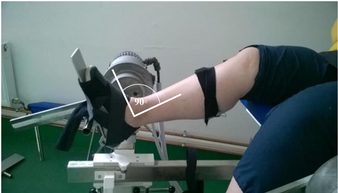
2. ábra. Lábpozíció a plantar-és dorsalflexió irányban végrehajtott maximális akaratlagos izometriás erő kifejtés teszteknél Multicont II számítógép vezérlésű dinamométeren.
