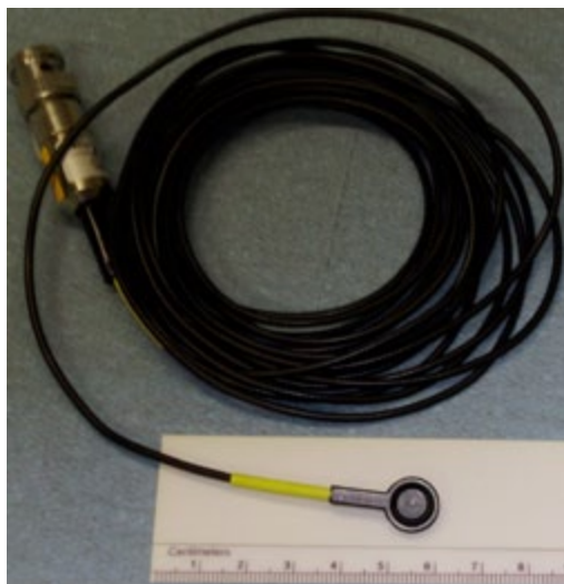
20.6. ábra: In vivo doziméter (PTW). Bőrfelszíni mérésre alkalmas félvezető detektor
