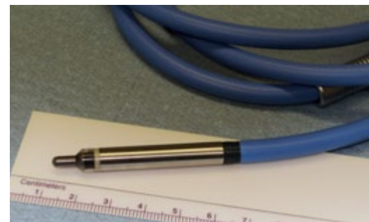
20.4. ábra: Pinpoint-kamra (PTW). Kicsi érzékeny térfogata miatt nagy dózisgradiensekben is jól használható
