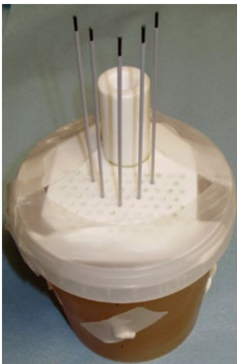
20.10. ábra: Polimer gél, prosztata brachyterápiás kezelés dóziseloszlásának verifikációjához. A kalibrált MR-alapú kiértékelésből adódó dózisértékek összevethetők a besugárzási tervből kinyerhetővel
