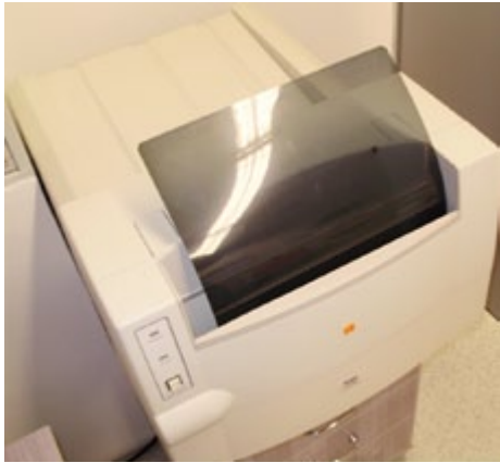
20.8. ábra: Filmdenzitóméter (Kodak). Az előhívott film bedigitalizálásával – megfelelő kalibrációt követően – kétdimenziós dóziseloszlást lehet mérni
