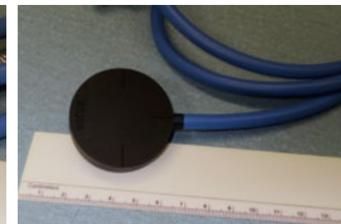
20.5. ábra: Plánparalel kamra (PTW). Két irányban viszonylag terjedelmes, cserébe a harmadik irányban nagyon érzékeny egészen kis elmozdításoknál is
