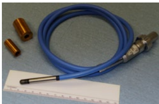
20.2. ábra: Gyűszükamra (PTW). A fekete „gyűszűformán” belül van az érzékeny térfogat. Felette különböző vastagságú vörösréz-sapkák az egyes fotonenergiákon történő mérésekhez
