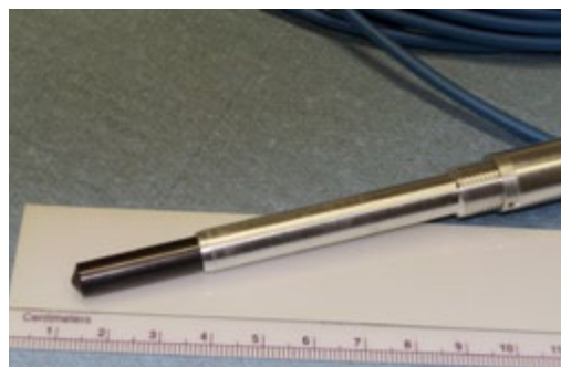
20.3. ábra: Farmer-kamra (PTW). Kúpos végződésű hengeres formája jellegzetes
