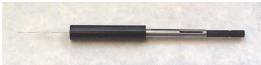
6.6. ábra Szilárd fázisú mikroextrakciós (SPME) készülék
