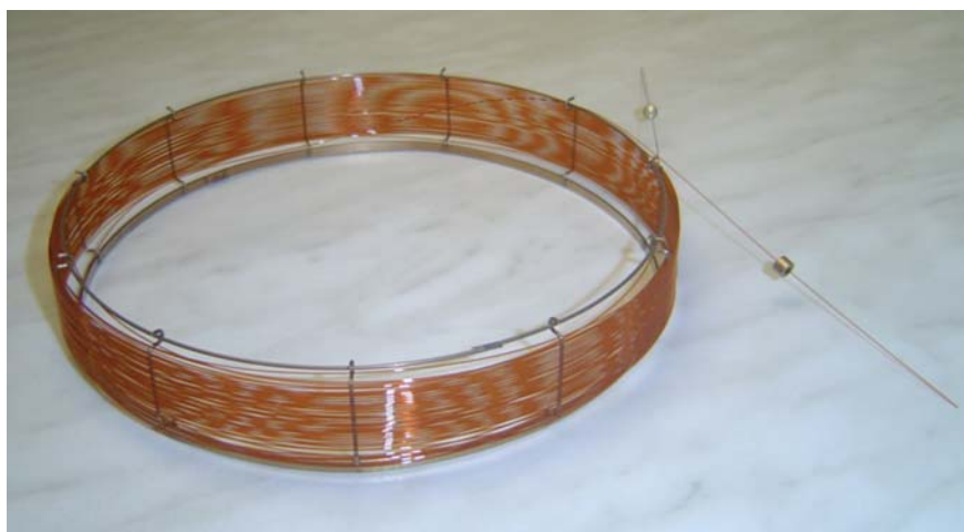
17.3. ábra Kapilláris gázkromatográfias oszlop
