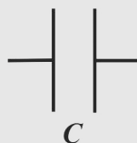
3.16. ábra: Kondenzátor technikai rajzjele
