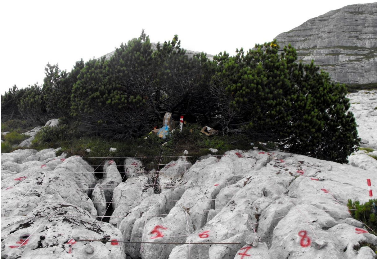
12. ábra. Fő- és mellékvályúk kijelölése számozással és a mérést, geomorfológiai térképezést segítő háló-mozaik elhelyezése egy rinnenkarr rendszeren. (Fotó: Széles László Gyula.)
