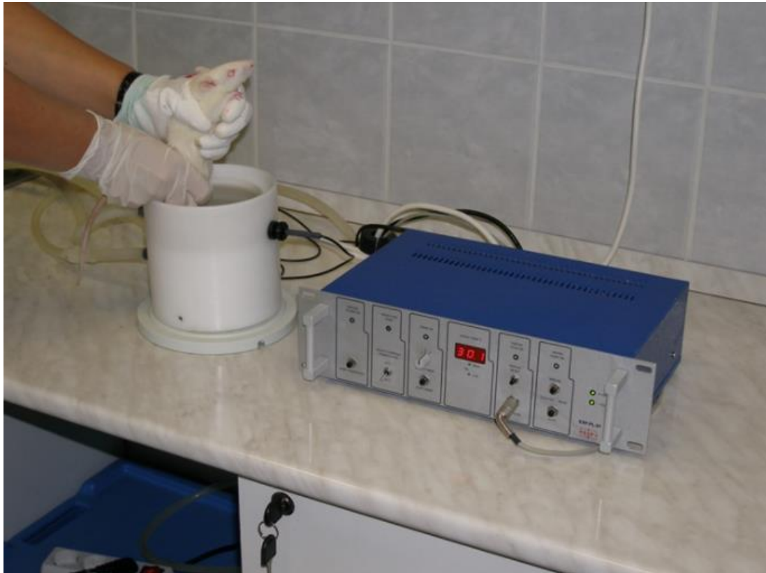
16. ábra: A hő kiváltotta fájdalomküszöb mérése
