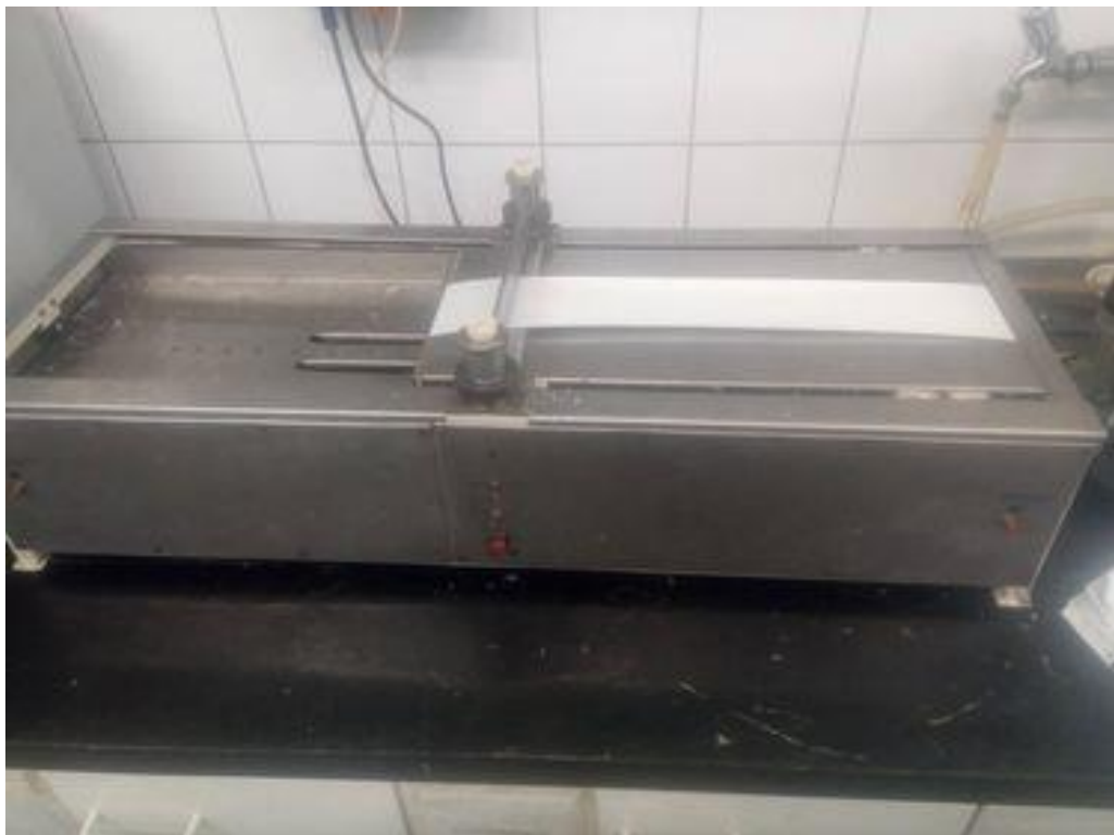
9. ábra: Készülék a polimer egyrétegű szétterítésére: A berendezés egyszerre egy 25 x 40 cm területű tapasz réteget képes elkészíteni. A réteg maximális vastagsága 2 mm, pontossága 0,05 mm lehet
