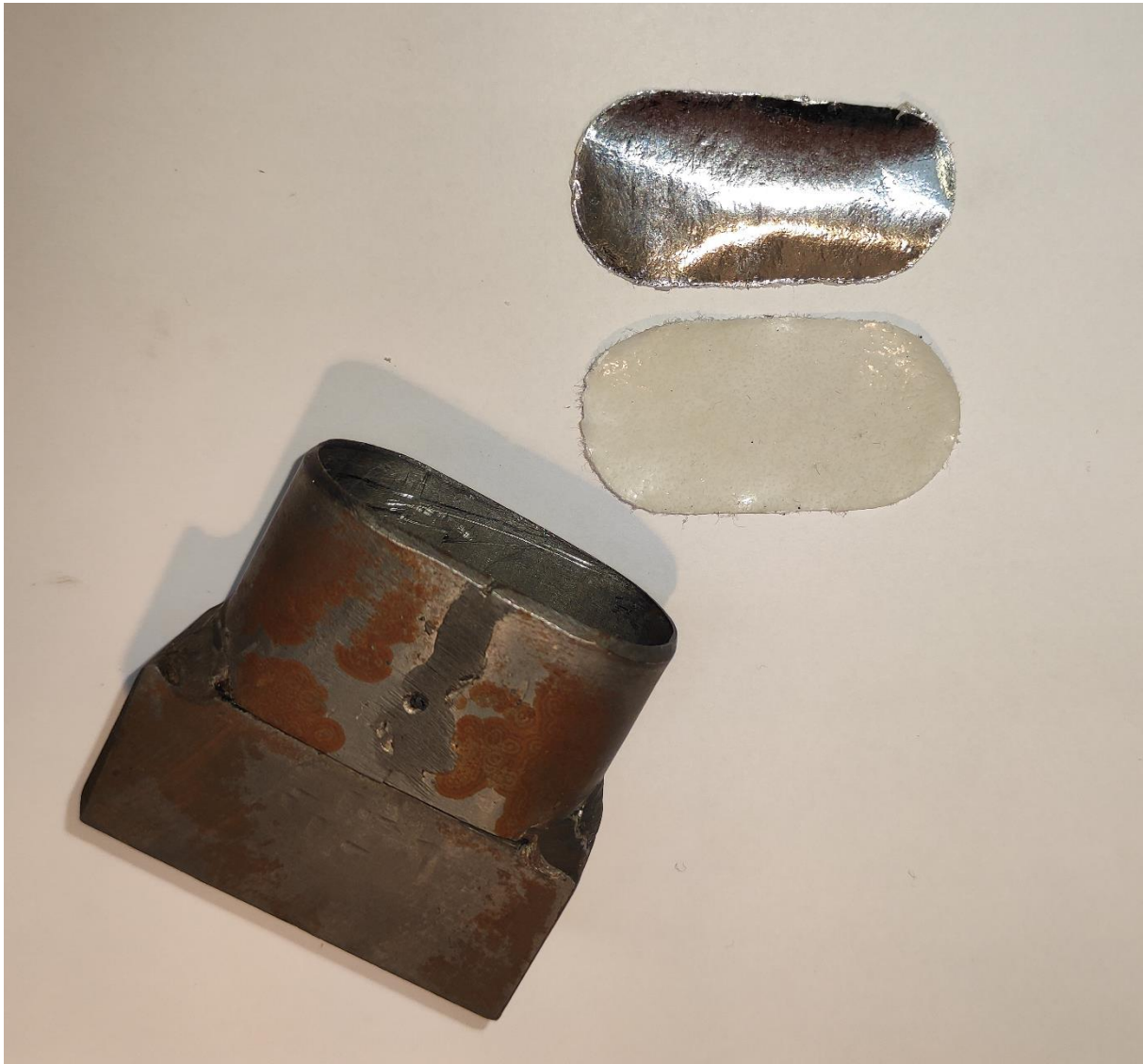
15. ábra: Az elkészült tapaszok, állatkísérletekhez előkészítve (3X6 cm méret), a stancoló szerszámmal
