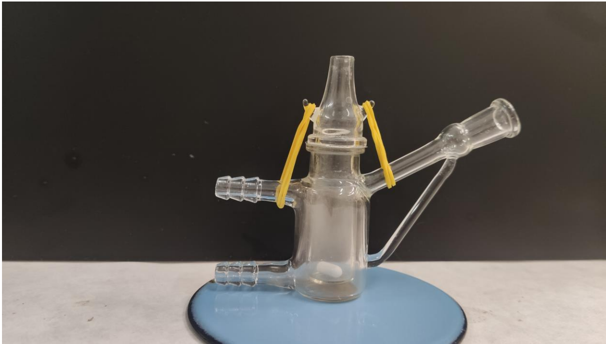
13. ábra: Franz típusú kioldódás mérő cella: A készülék a BME Üvegtechnikai műhelyében készült, irodalmi leírások alapján 69
