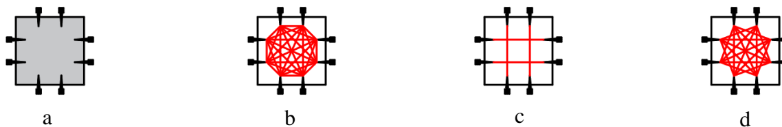
33. ábra Habarcs kockákon mért sugárutak sematikus elrendezése szónikus vizsgálat során [saját illusztráció]
