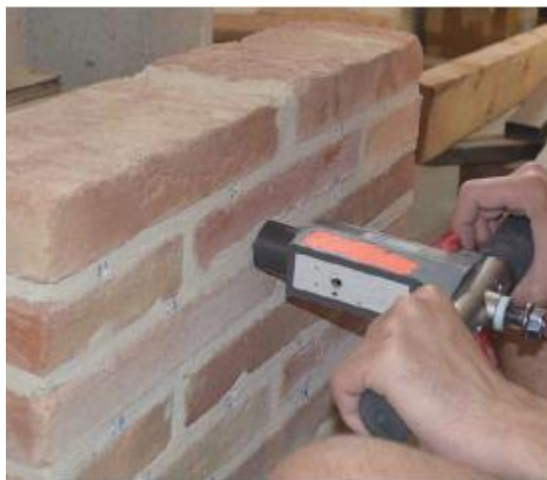
21. ábra Windsor féle penetrációs készülék használat közben [85]
