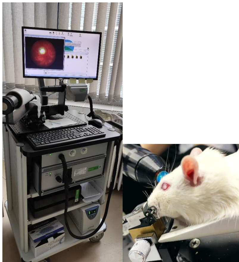
16. ábra: A Leica-Envisu™ R-Series SDOIS típusú OCT készülék és a mérés során az állattartó padon elhelyezett altatásban lévő patkány (forrás: saját kutatási anyag)
