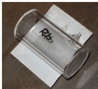
15. ábra – Üvegcellába zárt rubídium, amelyet a stabilizáláshoz használtam.
