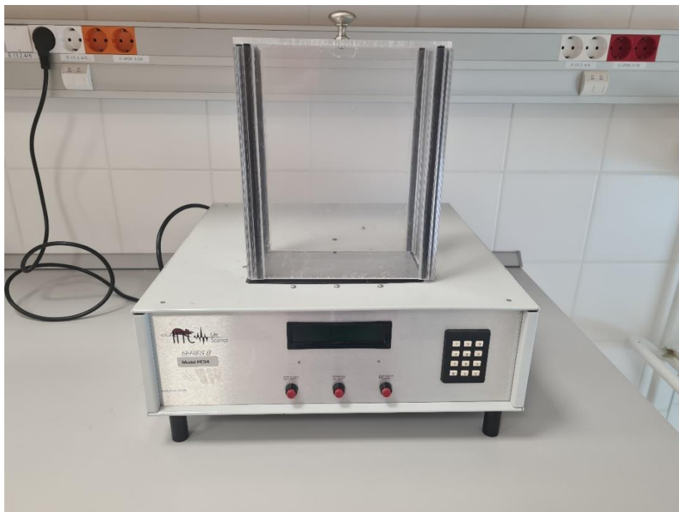
12. ábra Emelkedő hőmérsékletű forró lap - Hot Plate, ITC Life Science
