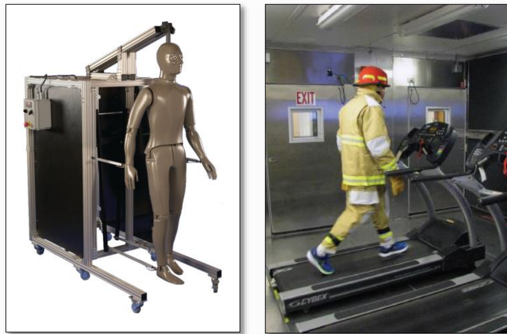
27. ábra Newton termikus mérőbábuk mozgatható testrészekkel [30]
