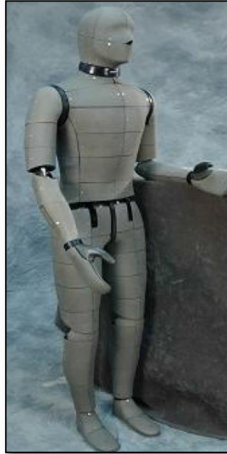
33. ábra Az „Adam” elnevezésű 126 szegmensből álló termikus mérőbábu [37]
