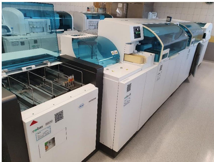
12. ábra. A rutin laboratóriumi mérésekhez és a gelsolin detektálásához használt Cobas 8000/c502 automata analizátor.
