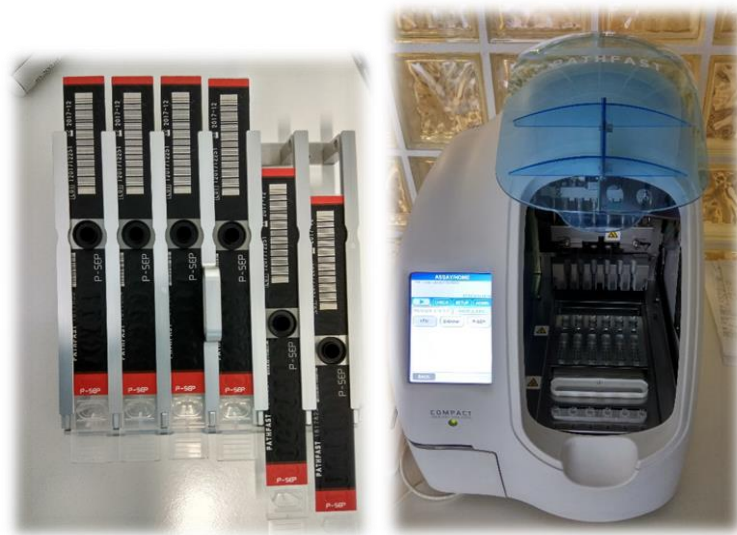
11. ábra. A PATHFAST™ presepsin kazetták (balra) és az automata készülék (jobbra).
