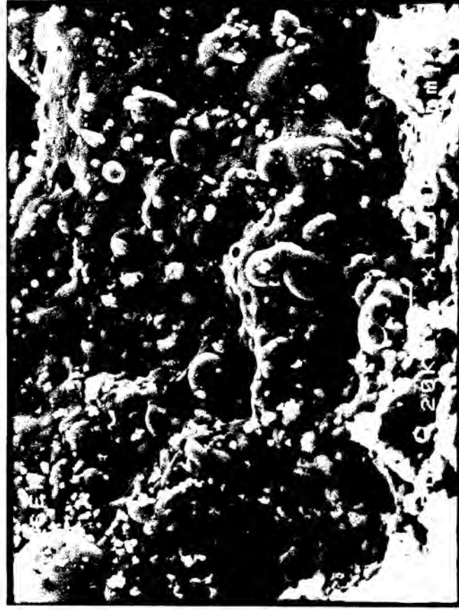
15. kép. CO 2 laserrel vágott felszín képe. Teljesítmény= 90 W, nagyítás=1000x, vágási sebesség=1 mm/s
