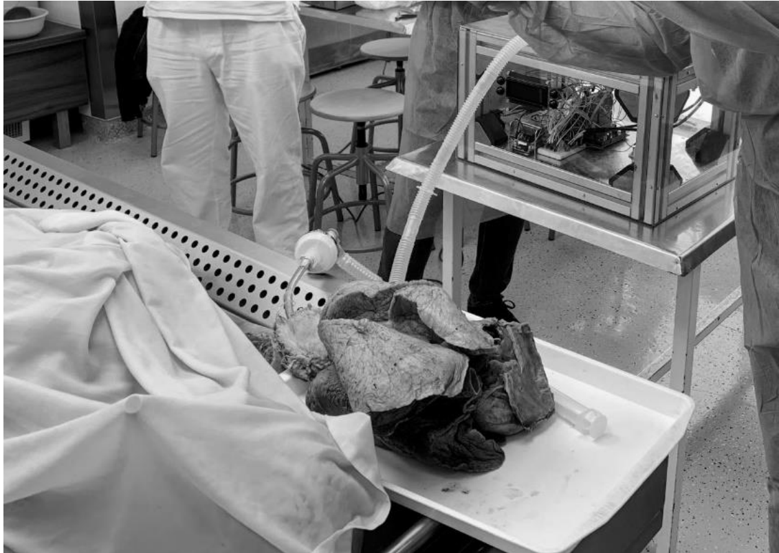
16. ábra. Saját kép. Additív gyártástechnológiájú improvizált lélegeztetőgép cadaver tesztje. (Kutatási együttműködés Magnus Aircraft Zrt.)
