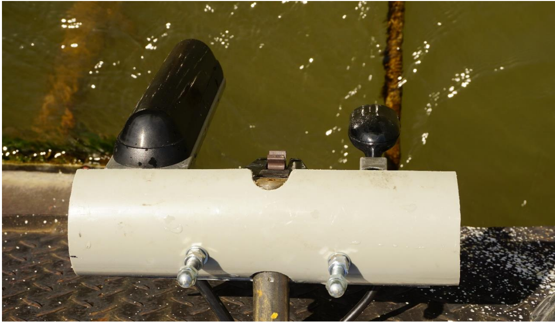
34. ábra. Áramlásjavító PVC félhenger a szonárokat és a vízsebességmérőt tartó horganylemez előtt. Bal oldalon a Lowrance® StructureScan® 3D szonárfej, középen a Lowrance® EP-70R lapátkerékes vízsebességmérő, jobb oldalon pedig a Lowrance® HST-WSU 83/200 kHz egycsatornás szonár látható. A StructureScan® 3D szonárfej tetején lévő műanyag peren alsó része egyvonalba esik az egycsatornás szonár középvonalával.
