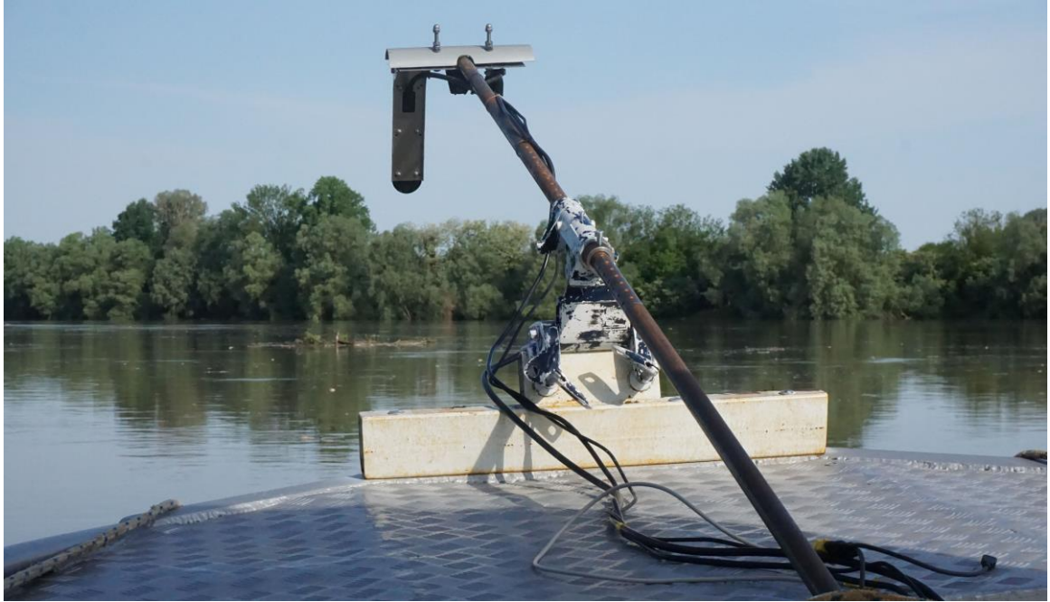
31. ábra. A mérőrendszer elhelyezkedése az orrban. A két szonárfej és a vízsebességmérő a rúd végén lévő hor-ganylemezekre rögzített. Szükség esetén az egész rudazat hátra hajtható, így a mérési területre a rendszer szétsze-relése nélkül is eljuthatunk – akár nagy sebességgel is. A rúd közepén szétcsavarható.
