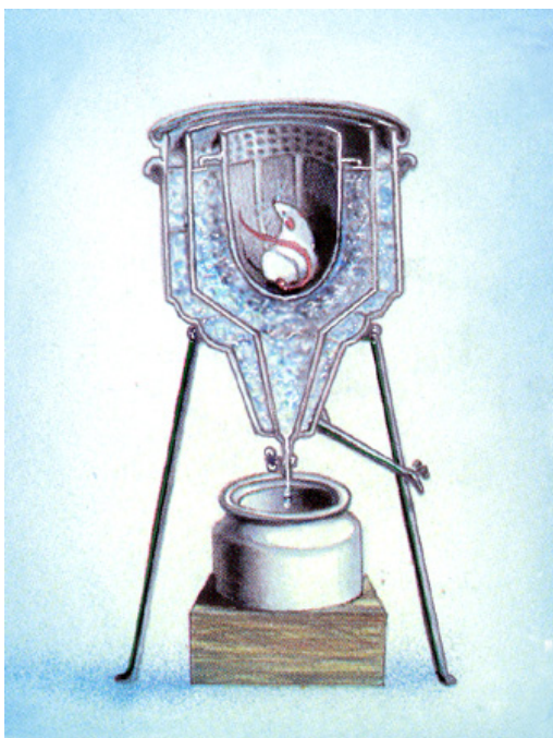
6. ábra Laplace és Lavoisier jégkaloriméter kísérlete 52
