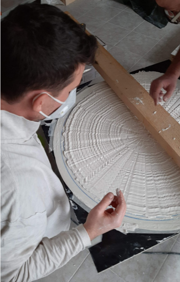
A kerámia műhelyben Zakar Istvánnal kézzel gipszből alakítjuk a fényvető korongok alapformáját.
