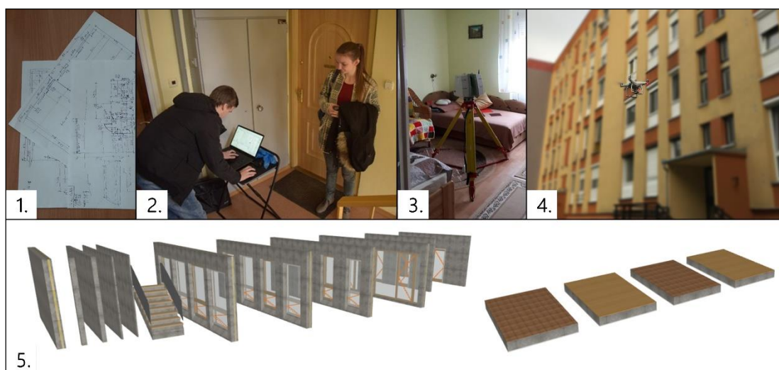
9. ábra A hagyományos (1.), helyszíni modellezés (2.), földi lézerszkennelés (3.), és sztereo-fotogrammetria (4.) felmérési eljárások illusztrációja és a BIM modellezéshez előkészített elemraktár (5.)
