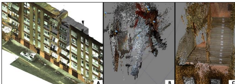
11. ábra Sztereo-fotogrammetriai eljárással készített pontfelhő állományok: A - homlokaz, B - konyha, C - lépcsőház
