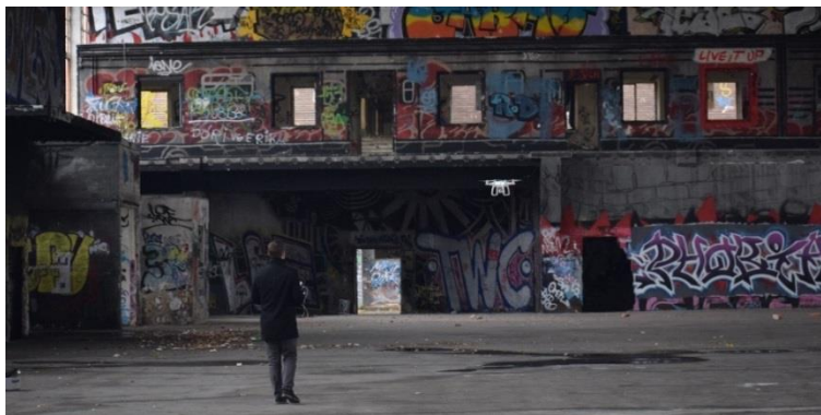
19. ábra Belső térben való UAV repülés a falgeometriák felmérése céljából
