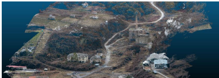
22. ábra A területfelmérés során generált sűrű pontfelhő állomány
