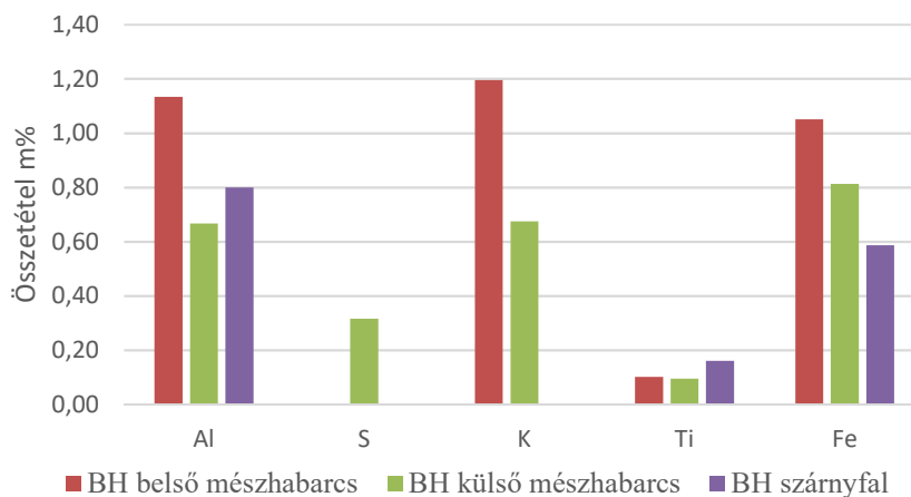
60. ábra: XRF vizsgálat eredményei boltozott hídszerkezet („BH”) habarcsminták
