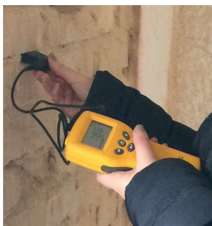
39. ábra : Felületi nedvességmérés Protiméterrel (saját felvétel)
