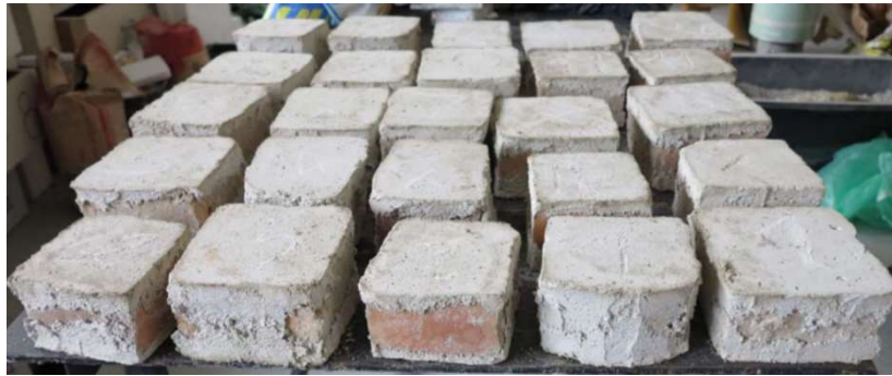
17. ábra: Kiegyenlített felületű szilárdság vizsgálatra előkészített téglaminták (saját felvétel)
