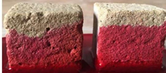
40. ábra: AS jelű mészhabarcs (bal oldalon) és CEM II jelű cementhabarcs (jobb oldalon) vízfelszívása az idő függvényében (saját felvételek)
