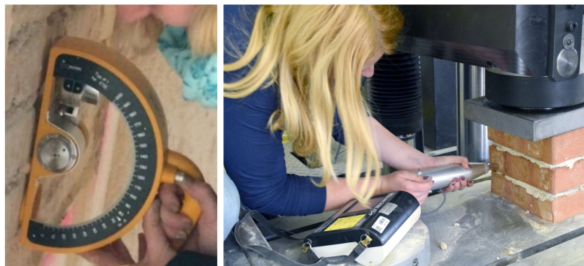
18. ábra: P-típusú OS-120 (bal oldalon, saját felvétel) és az N-típusú Schmidt kalapács (jobb oldalon, saját felvétel)
