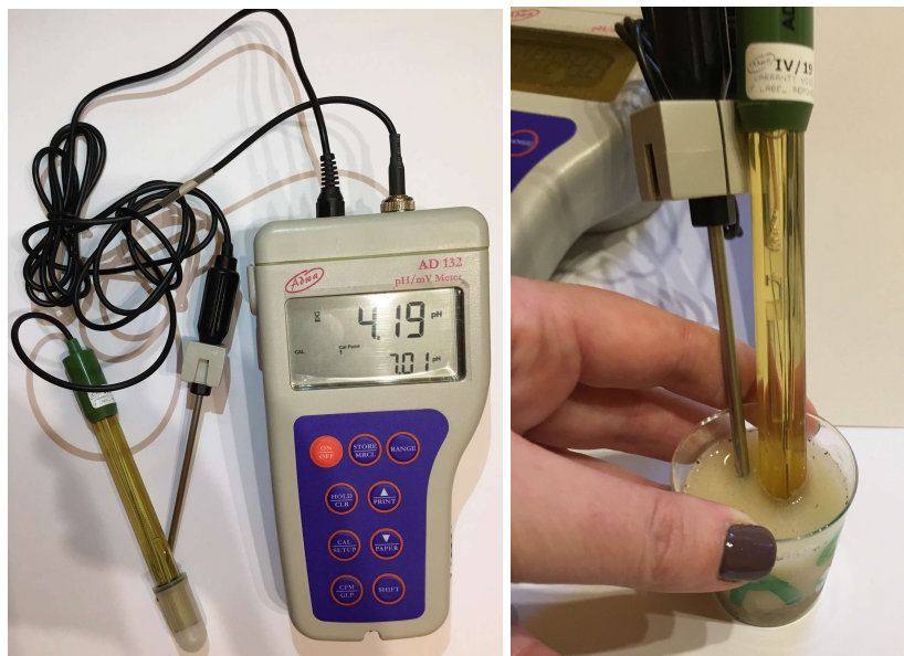
56. ábra: Adwa 132 terepi pH mérő (saját felvételek)
