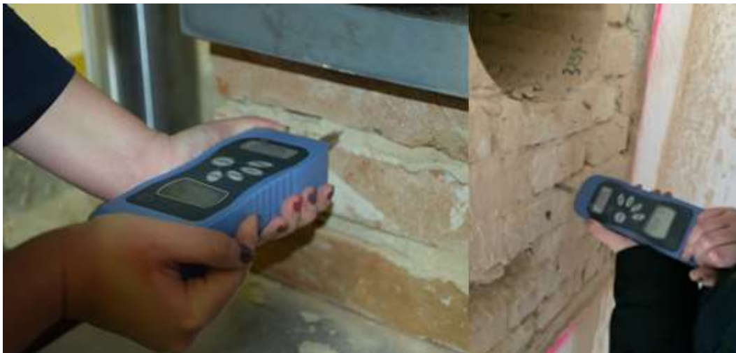
32. ábra: Penetrométer alkalmazása előterhelte próbatesten és függőleges falazaton (saját felvételek)
