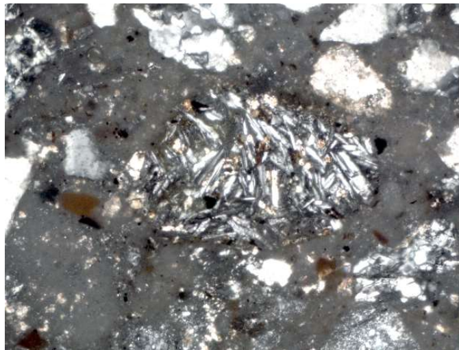
49. ábra: Gipszesedés boltozott híd szárnyfalából kiemelt habarcsmintán (saját felvétel)
