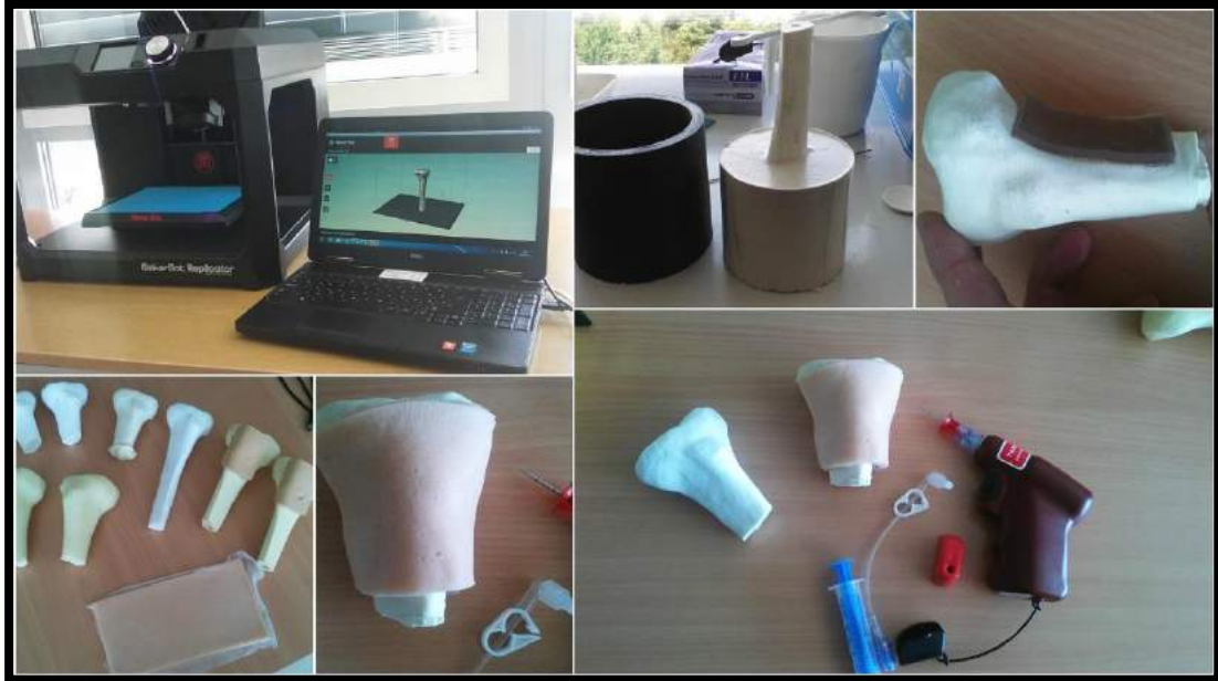
4. ábra: Intraossealis folyadékpótlást oktató modell fejlesztése 3D nyomtató segítségével. Dr. Maróti Péter, Dr. Varga Péter, Dr. Rendeki Szilárd. Saját felvétel
