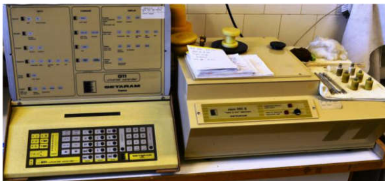
9. ábra: PTE ÁOK Biofizikai Intézet SETARAM Micro DSC-II kalorimétere
