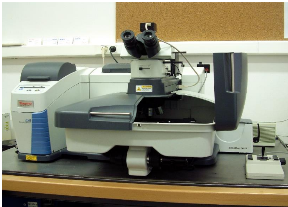
9. ábra: Thermo Scientific DXR Raman mikroszkóp (Szegedi Tudományegyetem, Természettudományi és Informatikai Kar, Ásványtani, Geokémiai és Kőzettani Tanszék).
