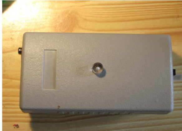
19. ábra Kapacitív cellával működő nyomásmérő és EMG/EKG erősítő
