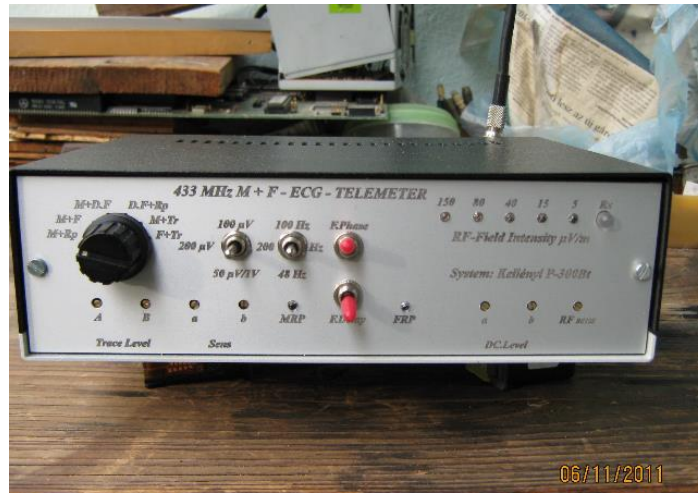
14. ábra 433MHz Maternal and Fetal ECG Telemeter Receiver - System Kellényi. Rádiófrekvenciás vevő és jelfeldolgozó egység.
