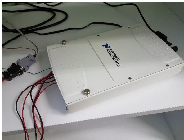
18. ábra A képen egy NI USB – 6281-es típusú A/D (analog-to-digital converter) konverter látható, mely 18 bit/minta felbontást tesz lehetővé igen nagy mintavételi frekvencián.
