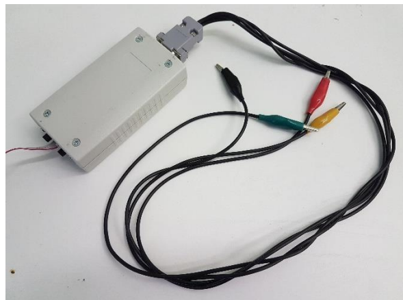
17. ábra Három csatornás, optikai leválasztású nagyfrekvenciás biológiai erősítő.
