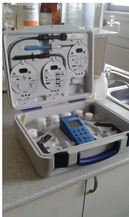
4. 2. 4. 1. fénykép: Schott kézi hordozható pH-vezetőképesség-oldott oxigén mérő (PÉCZ T. 2016)
