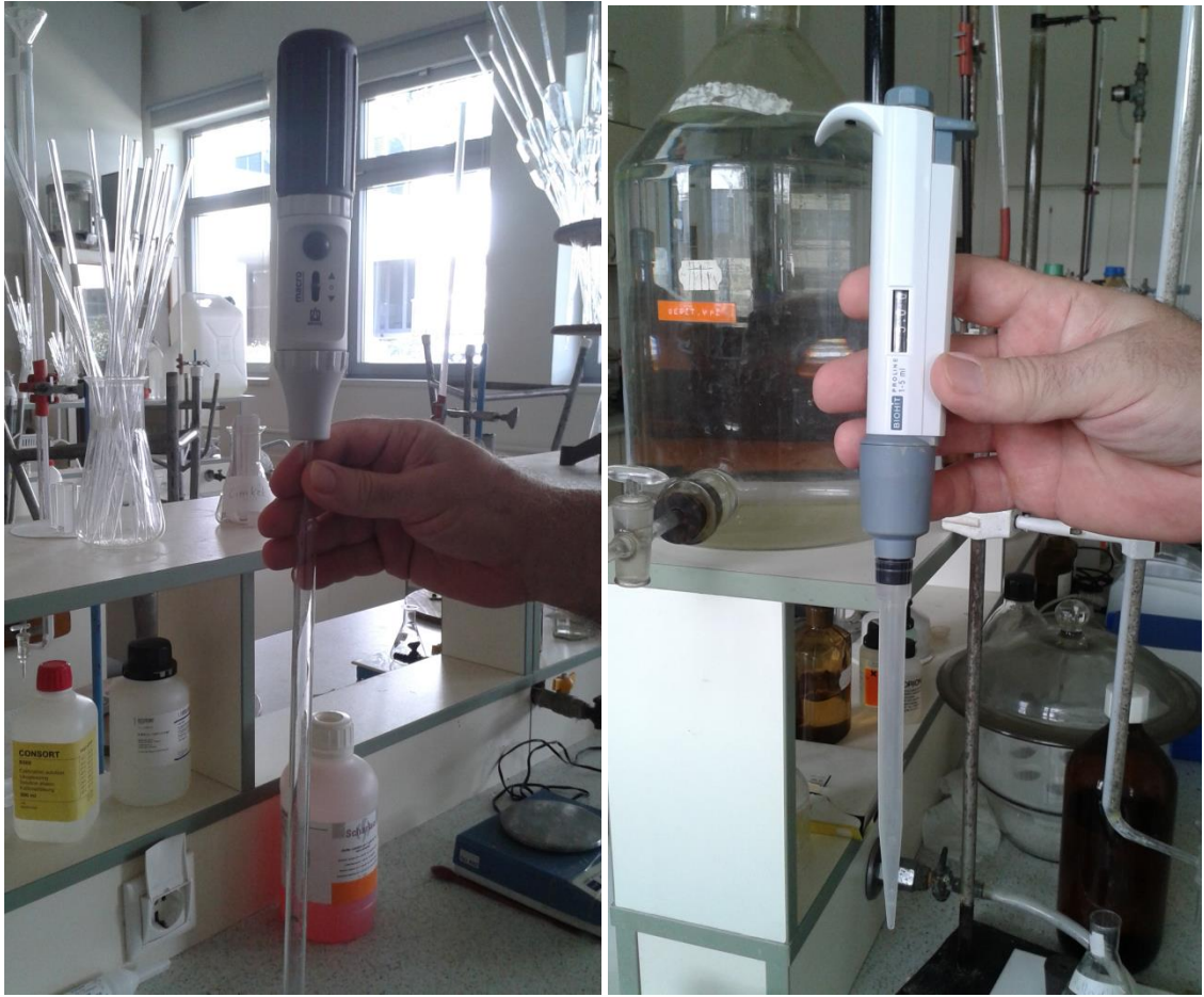
4. 2. 4. 12. fénykép: Félautomata és automata pipetták (PÉCZ T. 2016)
