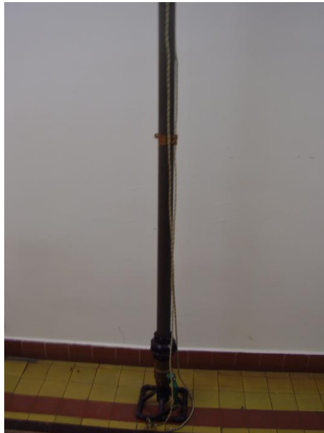
4. 4. 5. 1. fénykép: Vízoszlop mintavevő (CZIROK A. 2016)
