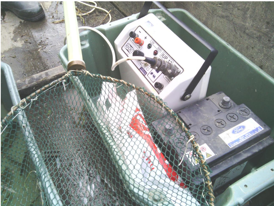
4. 5. 4. 2. fénykép: Radet egyenáramú, akkumulátoros halászgép (PÉCZ T. 2013)
