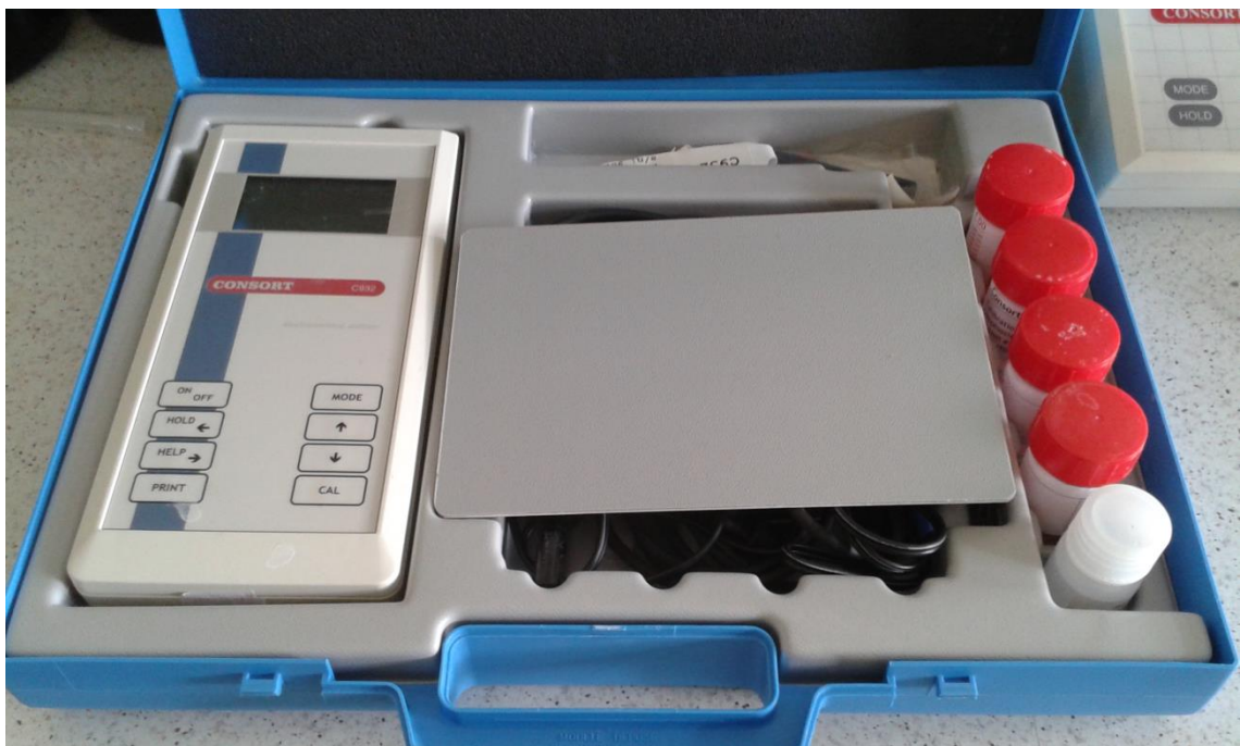
4. 2. 4. 10. fénykép: Consort kézi hordozható pH-vezetőképesség-oldott oxigén mérő (PÉCZ T. 2016)
