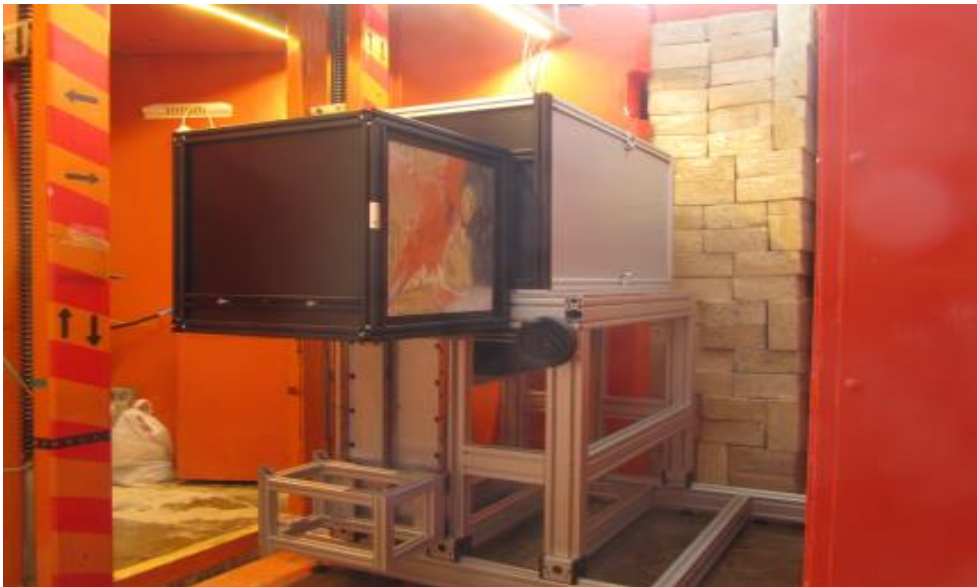
Bild 23: Digitales Aufnahmemodul der Versuchseinrichtung. Im Hintergrund sichtbar sind hellbeige Paraffinblöcke, welche zum „Abbremsen“ der Neutronen benötigt werden [81].
