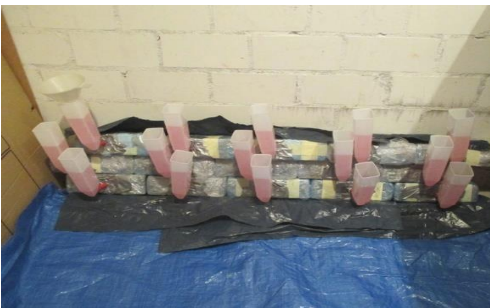
Bild 30: IM-Applikation von Mörtelprüfkörpern mittels Kartuschenverfahren [11]
