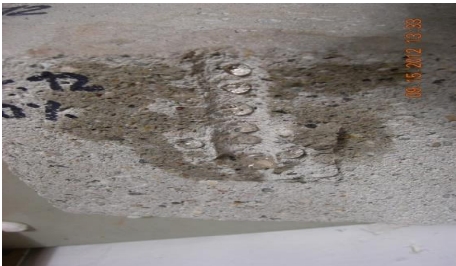
Bild 11: Hydrophobie von Mörtelprüfkörpern nach erfolgter IM-Applikation
