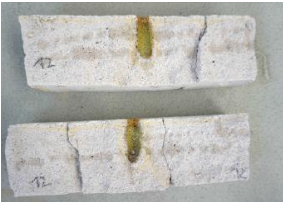
Bild 37: Ausbreitung IM bei D(g) 0%. Durch die Anfärbung des IM mit einem Farbstoff (Uranin) ist die Ausbreitung anhand der Verfärbung erkennbar [11]
