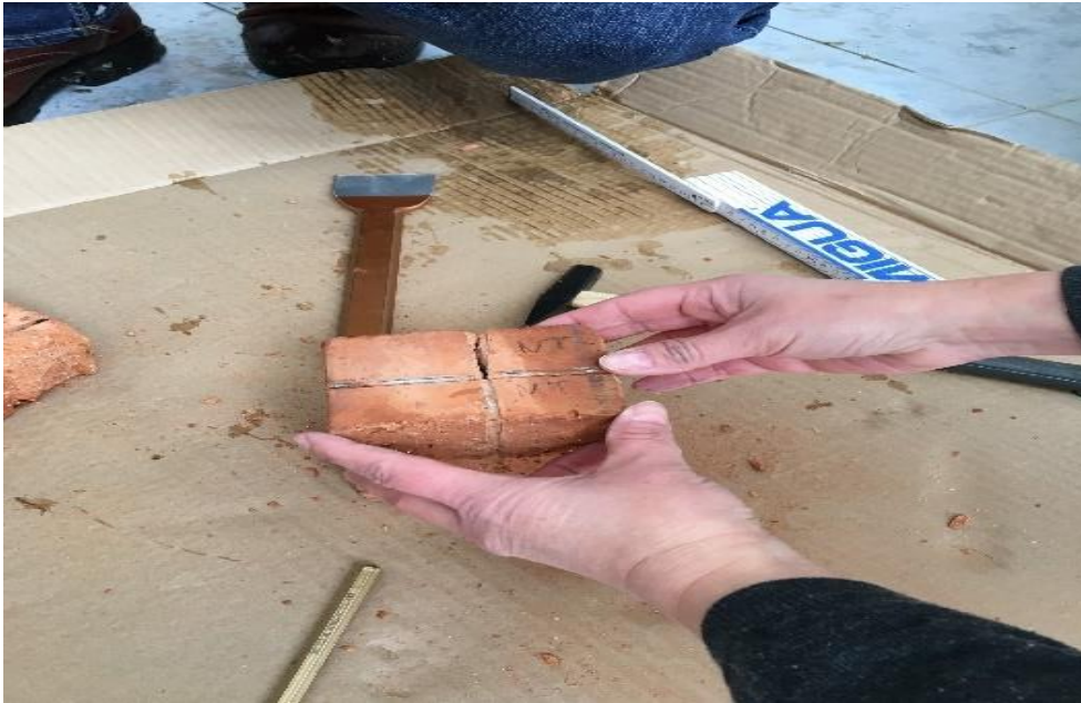
Bild 25: Probenvorbereitung zum Spalten der Prüfkörper. Erkennbar ist an der Oberseite eine Nut, welche vorab mit einem Winkelschleifer zum leichteren Spalten angebracht wurde.
