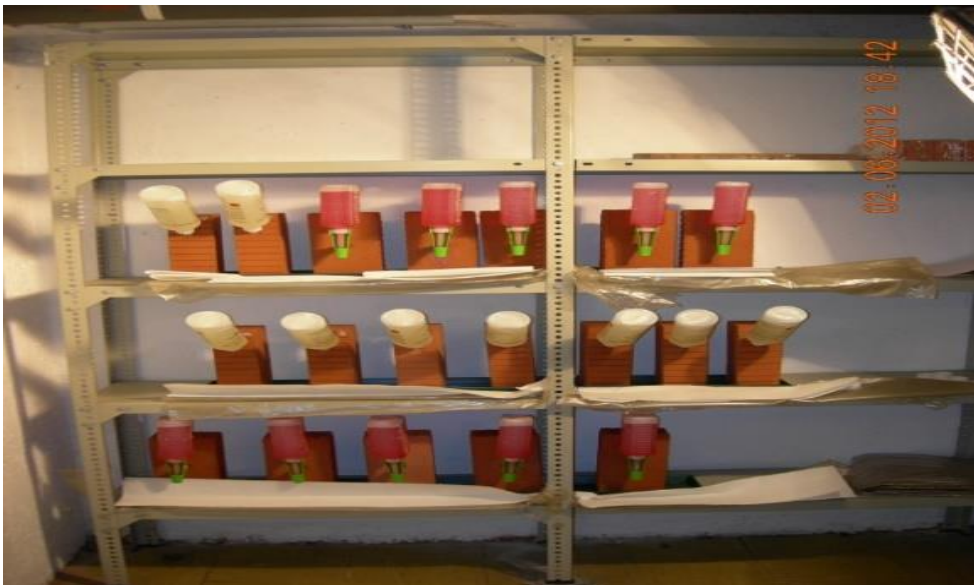
Bild 29: Applikation von IM in Ziegelprüfkörper im Kartuschen (IM farblos) und im Saugwinkelverfahren (IM rot)
