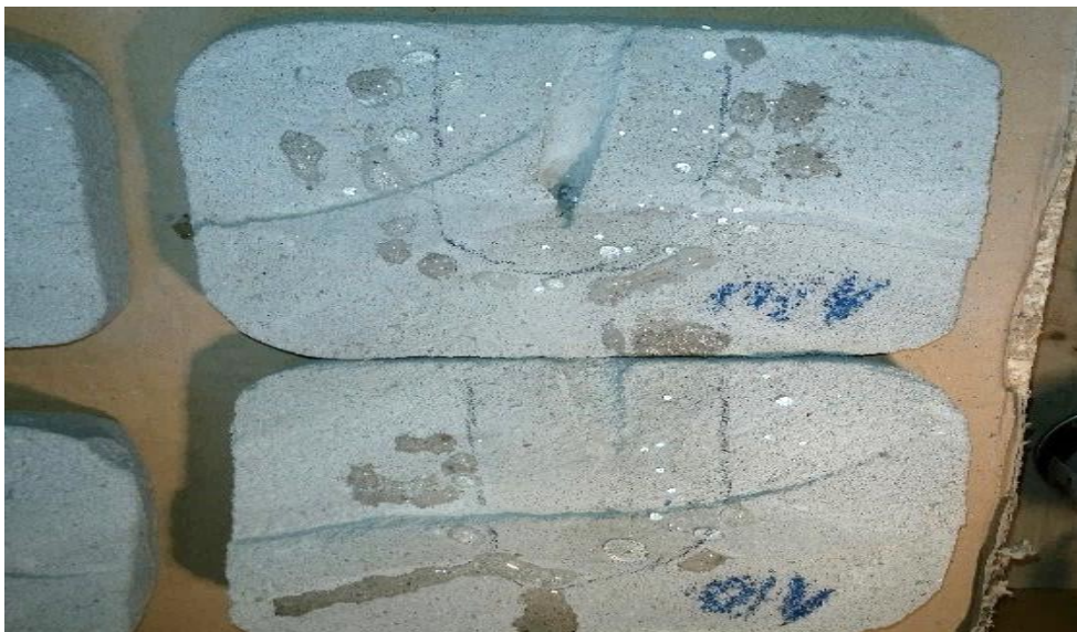
Bild 44 : Ausbreitung IM bei D(g) 80%. Um den Bohrkern herum zeigt sich ein ovaler hydrophober Bereich [11]
