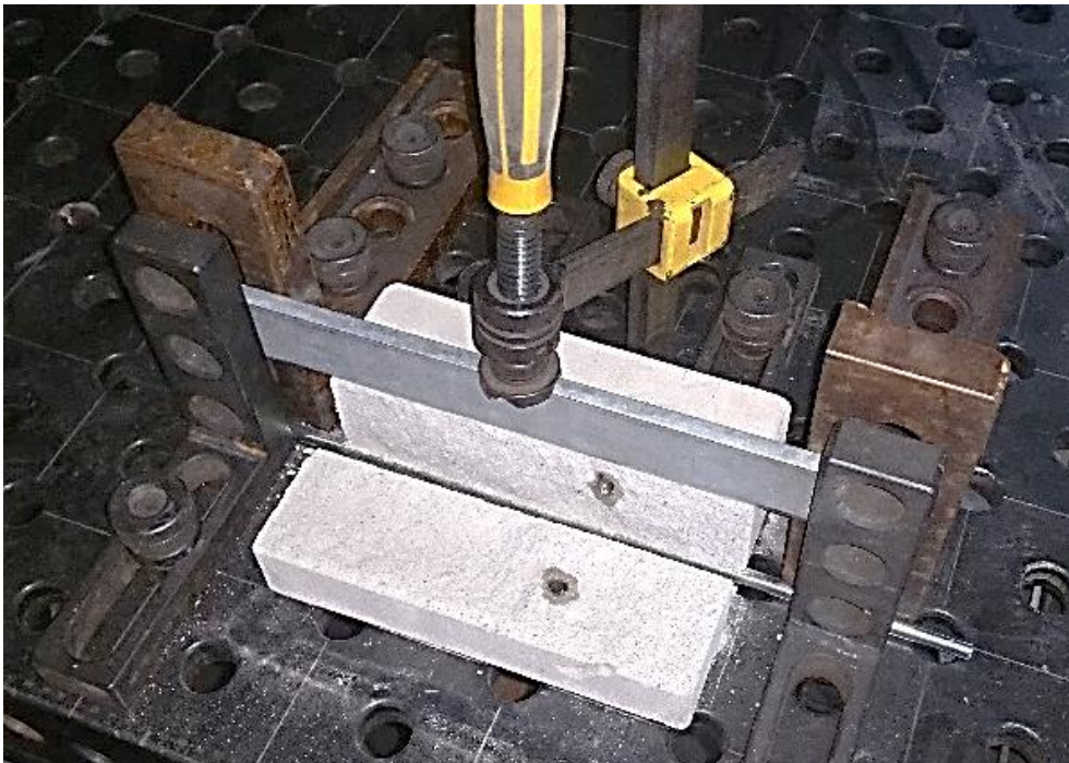
Bild 32: Auftrennen von Prüfkörpern mittels apparativer Vorrichtung. Durch Fixierung des Prüfkörpers und Einspannen mittels Zwingen sind nach Aufsetzen eines Hammers relativ gleichmäßige „Scheiben“ abtrennbar [11]
