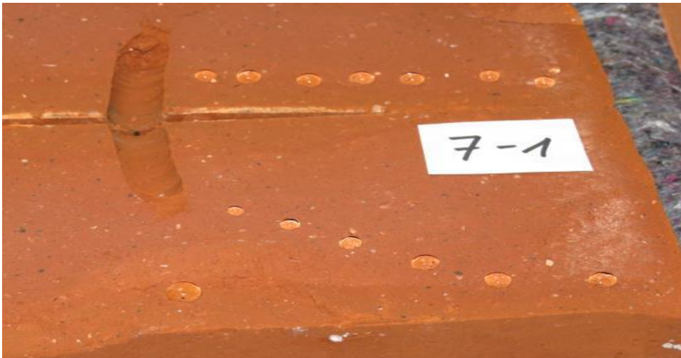
Bild 49: IM-Ausbreitung bei D(g) 40% (Fabrikat Matzen Tegl). Auffallend ist die große Ausbreitung des IM, welche sich fast über den gesamten Querschnitt des Prüfkörpers erstreckt [11]
