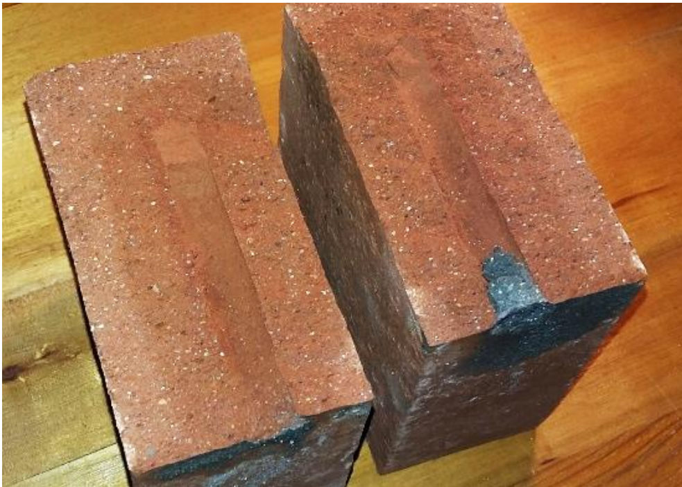
Bild 57: Ausbreitung IM bei Ziegel [11]
