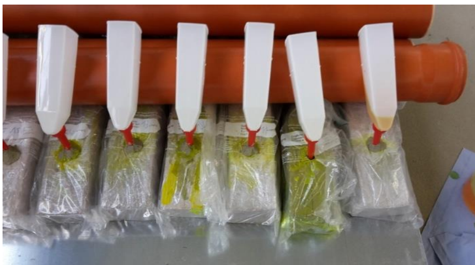
Bild 10: Verfärbung des Baustoffes durch Zugabe von Farbstoff zum IM [11].
