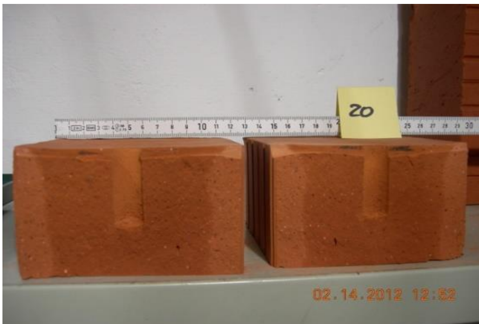
Bild 33: Visuell erkennbarer durch IM dunkel gefärbter Bereich des Baustoffes nach erfolgter Spaltung
