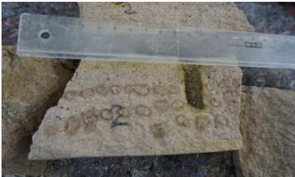
Bild 38: Ausbreitung des IM bei D(g) 40%. Auch im nicht sichtbar gefärbten Bereich ist eine teilweise Hydrophobie durch an der Oberfläche verbleibende Wassertropfen sichtbar. Dieser Bereich ist jedoch nicht durch Verfärbungen gekennzeichnet; offensichtlich findet der Transport von IM und Farbstoff nicht gleichermaßen statt [11]
