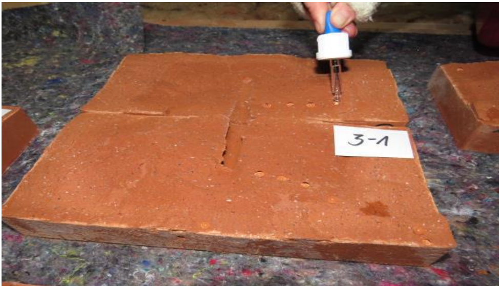
Bild 51: Tropfenaufsetztest [11]. Aufgrund eingetretener Hydrophobie und Veränderung des Randwinkels des aufgesetzten Wassertropfens verbleiben die aufgesetzten Tropfen an der Oberfläche
