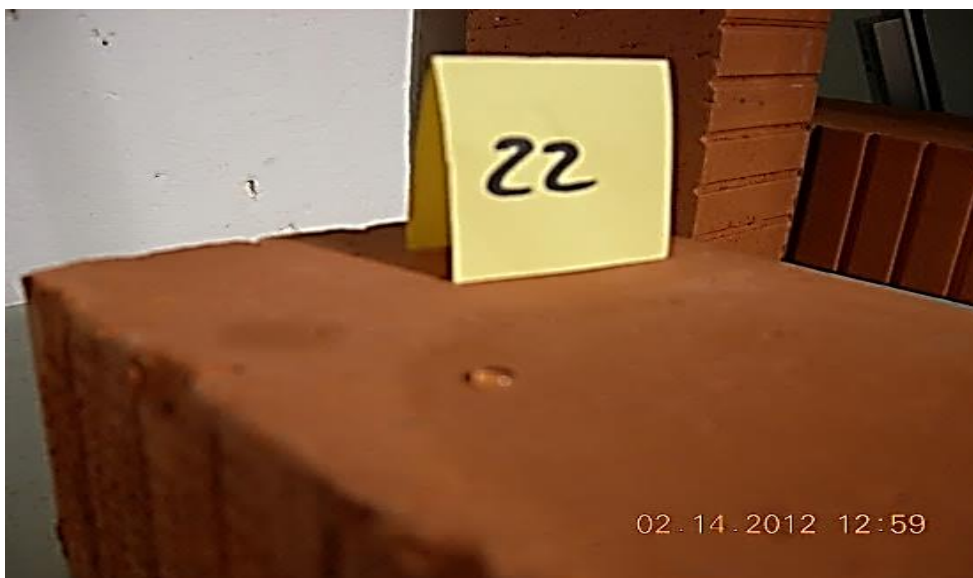
Bild 34: Verbleibender Wassertropfen aufgrund hydrophober Eigenschaften des Prüfkörpers nach IM-Applikation
