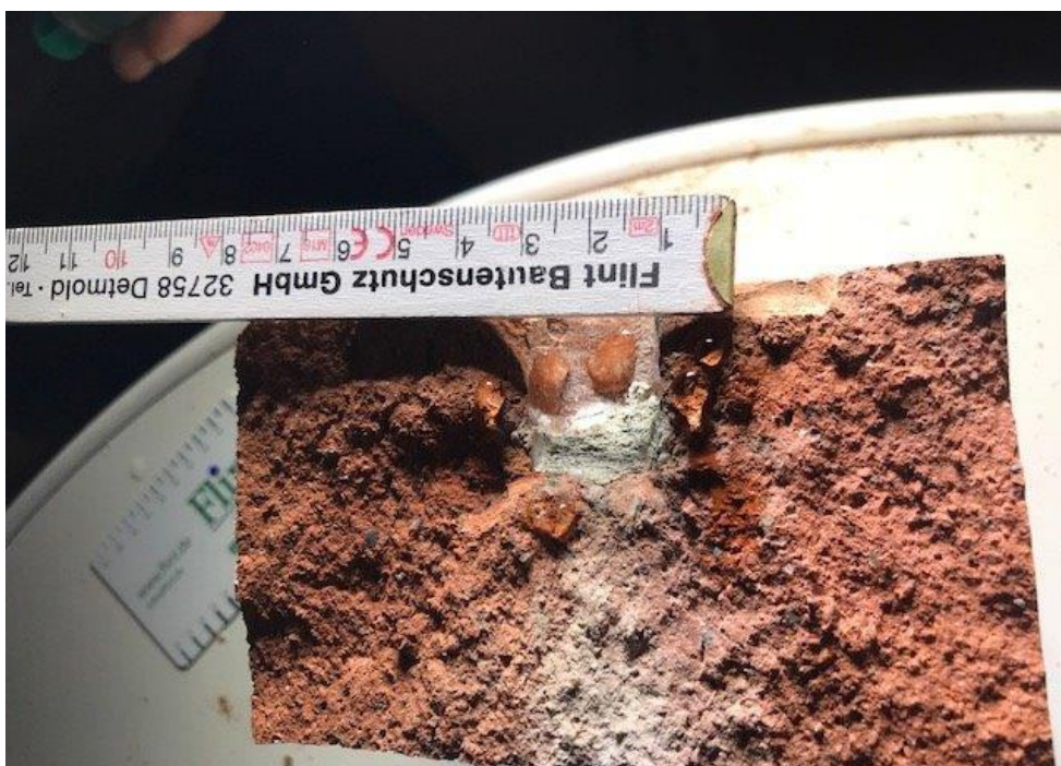
Bild 53: Ausbreitung IM Klinker bei D(g) 0% [11]
