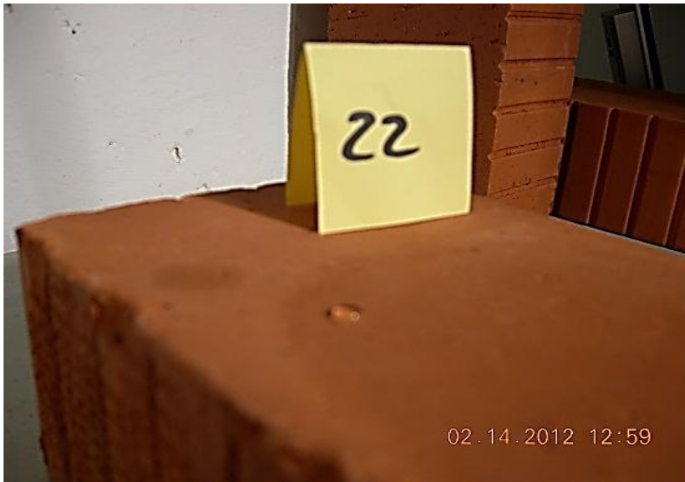
Bild 84: Prüfkörper nach erfolgtem Tropfenaufsetztest. Deutlich erkennbar ist das Verbleiben des Tropfens im hydrophobierten Bereich, während in der unbehandelten Region der Tropfen versiegt und in das Innere des Prüfkörpers weitergeleitet wird
