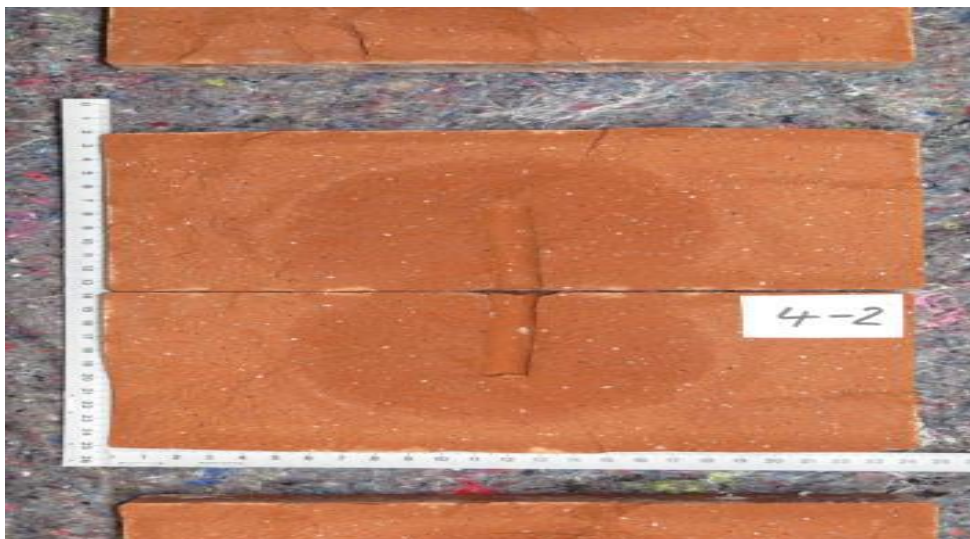
Bild 48: IM-Ausbreitung bei D(g) 80%, Fabrikat Wienerberger [11]. Die Dunkelfärbung des Klinkers im Bereich des Bohrloches resultiert aus der IM-Aufnahme.
