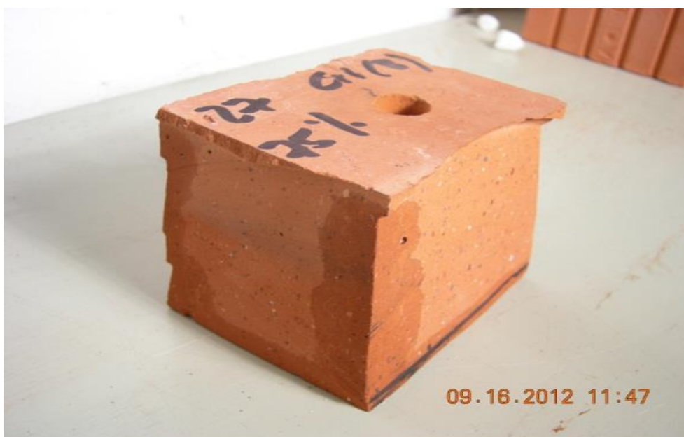
Bild 85: Uneingeschränkter Transport von Wasser im nicht hydrophobierten Bereich des Ziegels nach Ermittlung des w-Wertes. Die Ausbreitung des IM erfolgte eher konzentrisch, der Prüfkörper wurde jedoch rechteckig zugeschnitten. Infolge des Anteiles nicht hydrophobierter Bereiche erfolgte uneingeschränkte Wasseraufnahme
