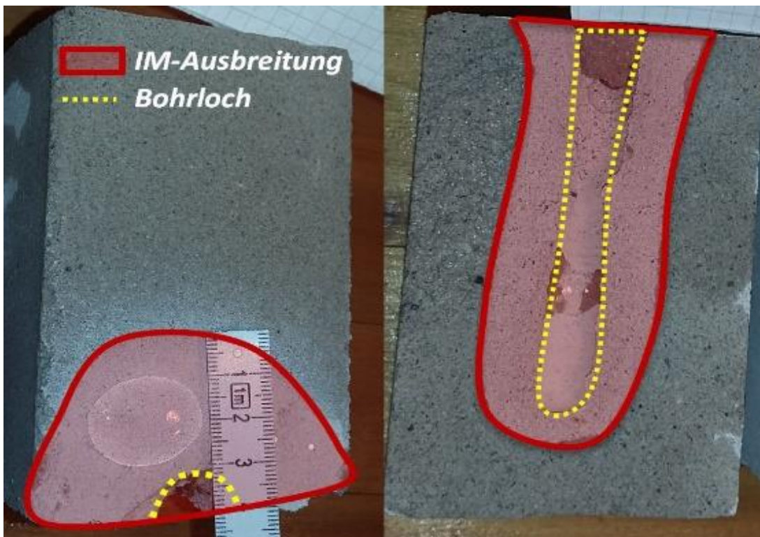
Bild 56: Ausbreitung im KS-Stein (farblich gekennzeichnet) [11]
