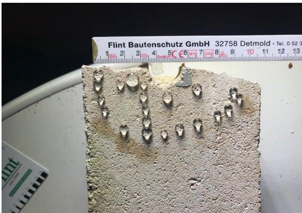
Bild 52: Ausbreitung IM KS-Stein bei D(g) 60% [11]
