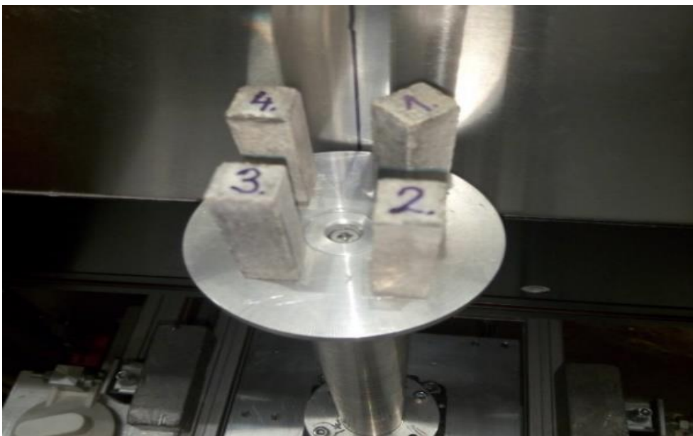
Bild 24: Drehbarer Probenhalter [81]. Durch jeweiliges Drehen des Probenhalters um wenige Grad mit nachfolgender Aufnahme können nach vollständigem Durchlaufen die erhaltenen Aufnahmen zu einer Tomografie „zusammengefügt“ werden.
