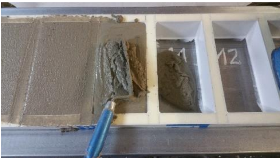
Bild 27: Herstellung von Mörtelprüfkörpern. Nach Anmischen des Werk trockenmörtels wurde dieser in entsprechende Schalungen zum Abbinden verfüllt. Die entsprechende Nummerierung der Prüfkörper wurde bereits vor dem Einfüllen „eingearbeitet“ [11]
