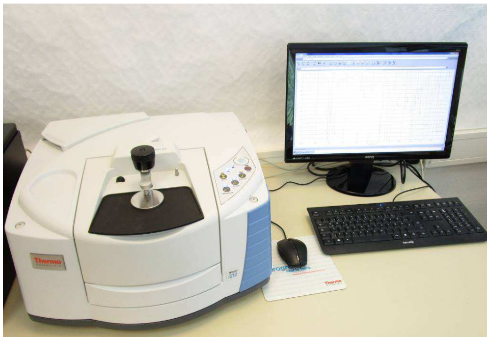
Abb. 94: Materialanalyse per IR-Spektroskopie, Thermo-Fisher-FTIR-Spektrometer, Typ Nicolet iS10 [116].
