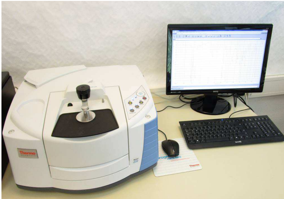
Materialanalyse per IR Spektroskopie, Thermo-Fisher-FTIR-Spektrometer, Typ Nicolet iS10
