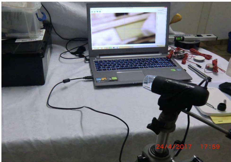
Abb. 84: Mikroskop zur Benetzungswinkelmessung.
