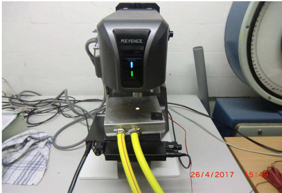
Abb. 51: Versuchsaufbau mit Laserscanmikroskop Keyence VK 9700 und Kühlplatte.
