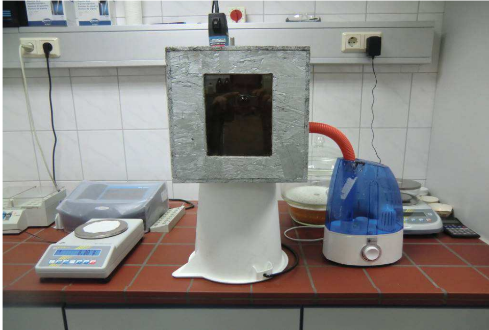
Abb. 44: Versuchsaufbau zur Tauwassermessung mit einem Dampferzeuger und anschließende Wägung.
