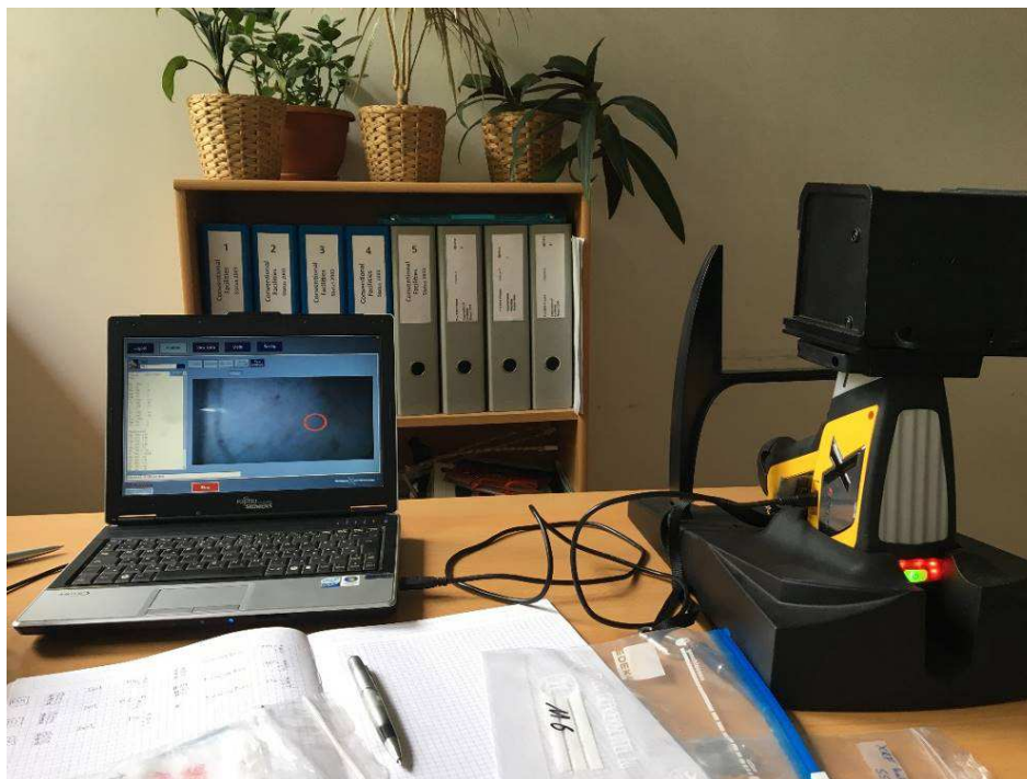
Abb. 90: Materialanalyse per Röntgenfluoreszenzanalyse (RFA), mit dem Olympus XRF, hier beim Messvorgang [108].
