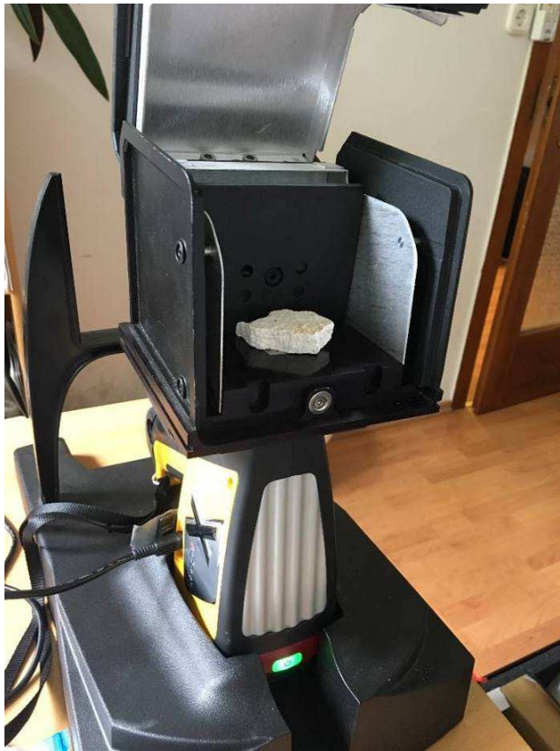
Abb. 89: Materialanalyse per Röntgenfluoreszenzanalyse (RFA), mit dem Olympus XRF [108].
