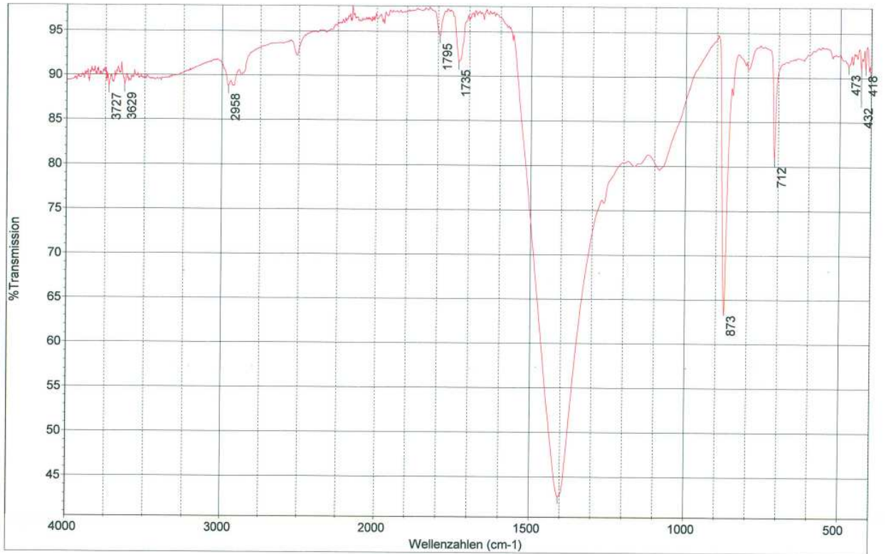
Abb. 95: Beispiel Wellenschwingung mit Wellenzahlen der IR-Spektroskopie der Probe O1 [117].
