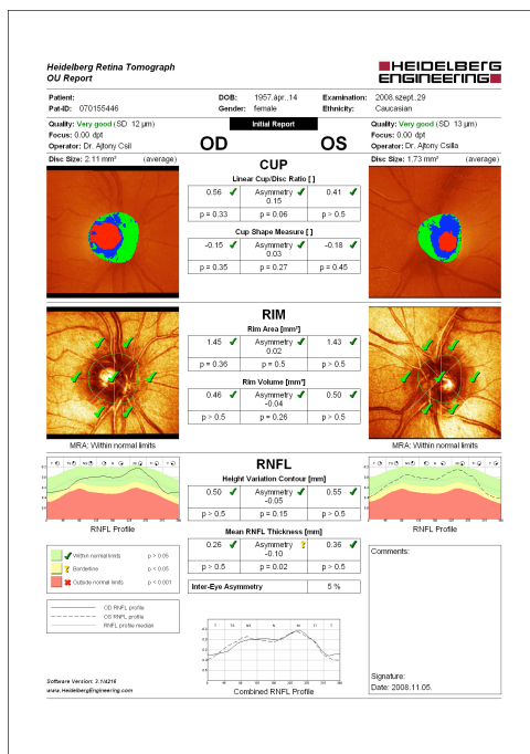
5. Ábra Scanning Lézer Oftalmoszkópiás regisztrátum (bal oldali kép): jobb és bal szemre vonatkozó adatokkal és azok normatív adatbázishoz viszonyított értékeivel a papilla mélyedése (cup), a peremterület (rim) és a peripapillaris régió (RNFL) vonatkozásában. Felül egy színekódolt kép a peremterület (zöld), a cup lejtése (kék) és a cup területe (piros) szerint. Középen a perem felrajzolása utáni automata elemzés (minden szegmens normális tartományon belül, zölddel "kipipálva"), legalul pedig a peripapillaris rostrajzolat. Jobb oldali kép: a Glaucoma Probability Score – GPS - analízis szoftver a glaukóma valószínűségét jeleníti meg a perem manuális felrajzolása nélkül.
