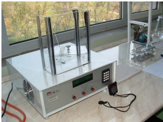
4. ábra. Az „incremental hot plate” készülék (IITC Inc. Life Science, Woodland Hills, CA, USA) központi egysége a fűtőrendszerrel, kezelőszervekkel és a megfigyelő kamrával (bal oldalon), illetve a megfigyelő kamrában a melegített lapra helyezett állat lábemelési reakciója (jobb oldalon).
