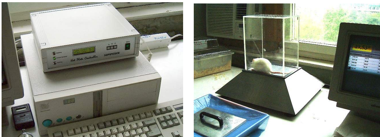
3. ábra. Az emelkedő hőmérsékletű forró lap (Supertech Kft., Pécs) kezelőegysége a számítógéppel (bal oldalon), illetve a fűtőegységgel egybeépített fémlap a megfigyelő kamrával, előtérben a hűtéshez használatos fémlap (jobb oldalon).
