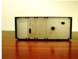
17. ábra. A KEEC MRI vizsgálóhelyiségében levő Shielded Interface Unit melyhez csatlakozik a vizuális és audió rendszer [KEEC].
