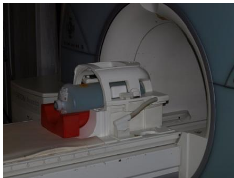
13. ábra. 12 csatornás phased array koponya tekercs gyári fantommal [KEEC].
