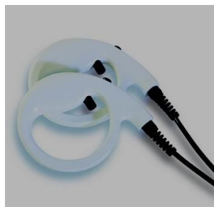
16. ábra. A NNL fMRI rendszer két különálló válaszadó markolata, amelyeken megtalálható 2-2 válaszreakció gomb [131].
