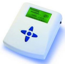
18. ábra. A NNL fMRI rendszer szinkronizációs egysége amely szinkronizálja az fMRI stimulusokat és RF impulzusokat [131].
