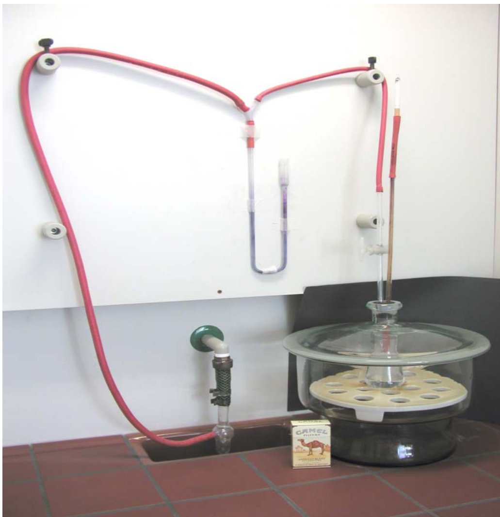
17. ábra: A DFP előállítására alkalmas készülék. A DFP-t filteres cigaretta füstjének egy vákumcsőszivattyú segítségével Krebs-pufferbe történő szívásával állítja elő.
