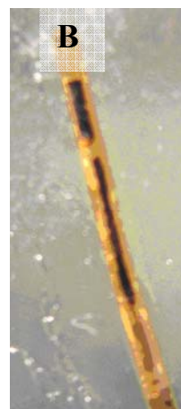
8. ábra: A CGMS készülés glükóz szenzora (A panel). A subcutan implantálható tűelektród mikroszkópikus szerkezete (B panel) A B panelen fénymikroszkóp alatt vizsgálva látható a mikroelektród 3 alkotóeleme: a munka-, a referencia és az ellenelektród.
