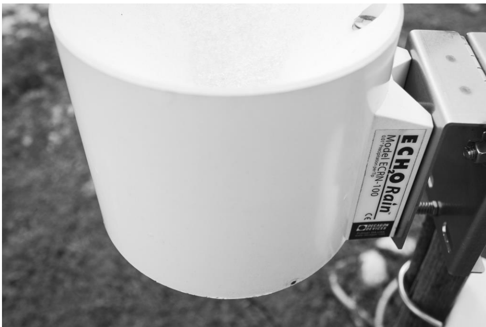
41. ábra Decagon ECRN-100 típusú, billenőedényes elven működő csapadékmérő (Saját fotó)
