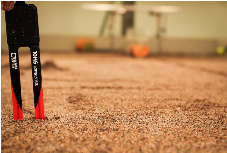
45. ábra 10HS típusú Decagon talajnedvesség ( soil moisture ) mérő szenzor (Saját fotó)
