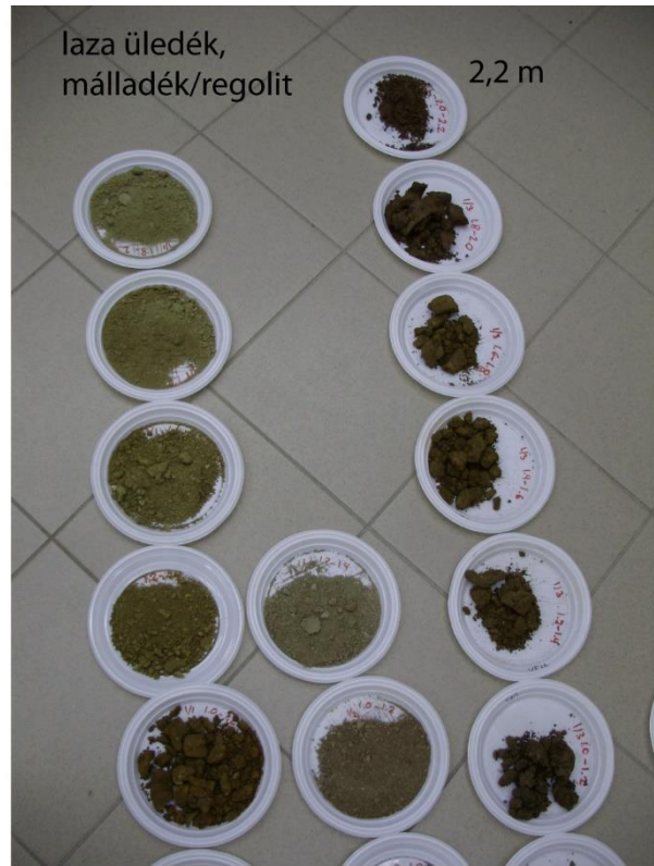
97. ábra Néhány GeoS Bt. által a Pósa-völgyben mélyített fúrás 20 centiméterenként vett talajmintái. A maximális fúrástalp az itt bemutatott esetekben 2,2 méter volt. (Fotó: Keresztény Balázs)
