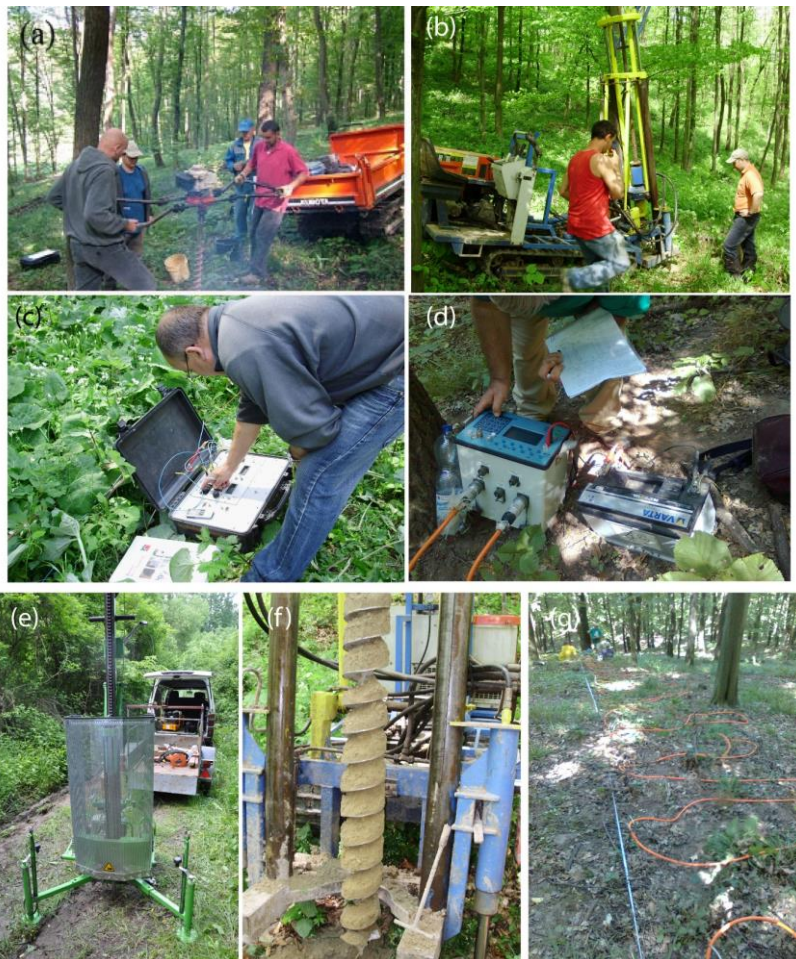
59. ábra A talaj- és termőrétegvastagság meghatározása közben használt eljárások: (a) Stihl BT 360 kézi talajfúró használat közben. (b) Kubota KCR 121 R típusú önjáró fúrógép (c) RESP-12 VESZ kezelőfelülete, (d) multielektrodás szonda kezelőfelülete (e) dinamikus szondázás, (f) fúrásmag-minta a Pósa-völgy É-i részéből, (g) multielektrodás szonda kábelhálózata (fotó: Czigány Szabolcs)
