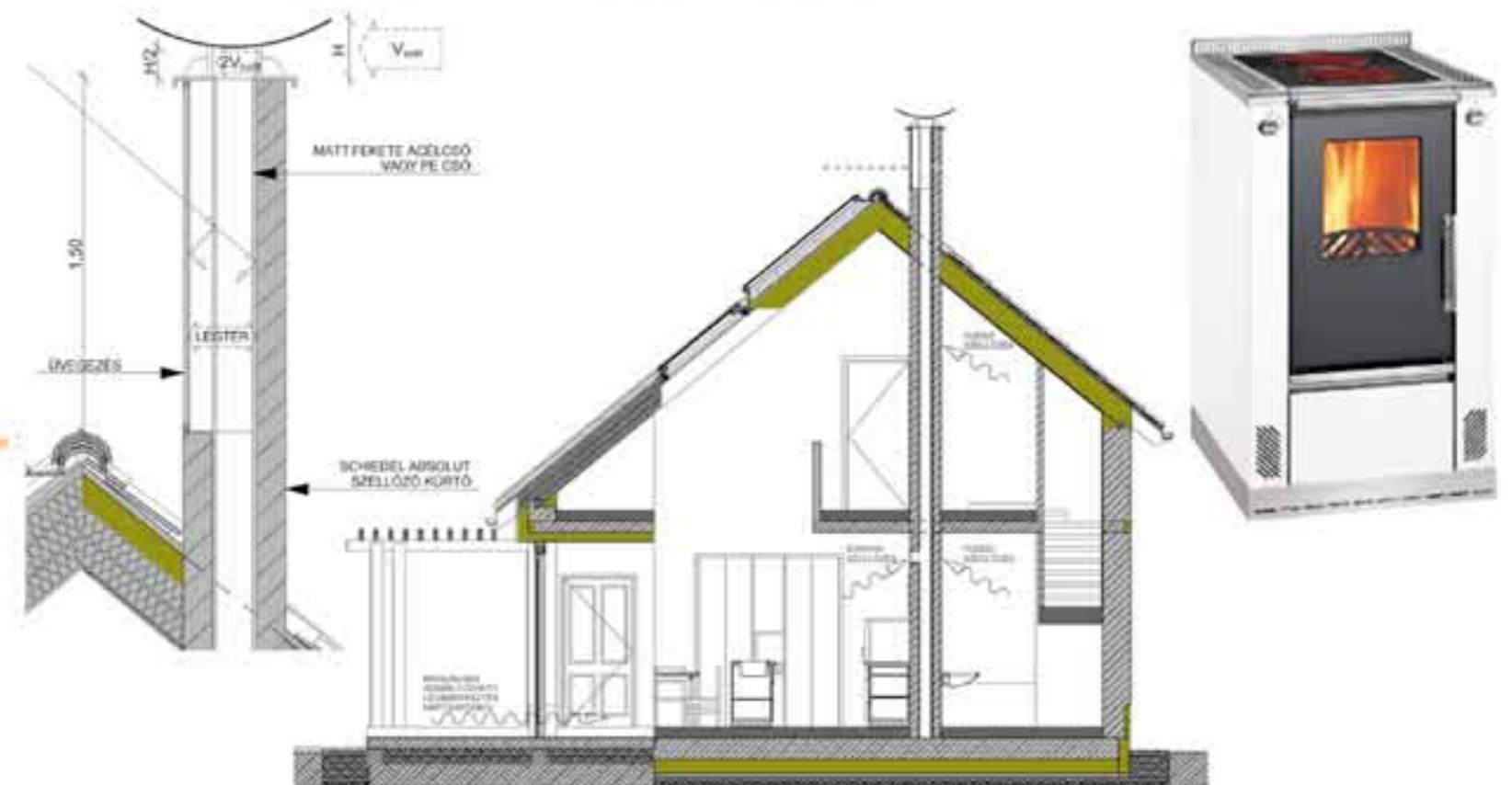
Passzív szellőzés, szélkémény Venturi-tárcsával, szolárkémény, gravitációs szellőzés, naptér.
