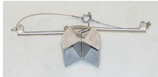
15. ábra Van Veen-féle mintavevő kanál (Forrás https://www.environmental-expert.com/products/eijklkamp-model-043001 )
