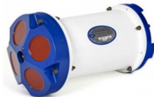
16. ábra ADCP műszer (forrás https://scientificservices.eu/item/direct-reading-acoustic-doppler-current-profiler/1519 )
