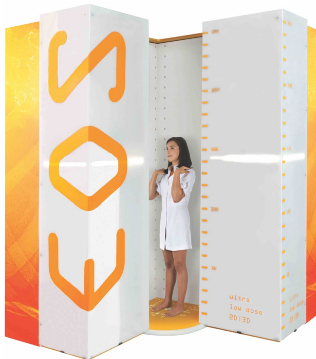
1. ábra. Az EOS szkennер biplanáris képalkotó eszköz, két röntgenforrással és érzékelővel. [A kép az eos-imaging.com (Párizs, Franciaország) engedélyével készült.]
