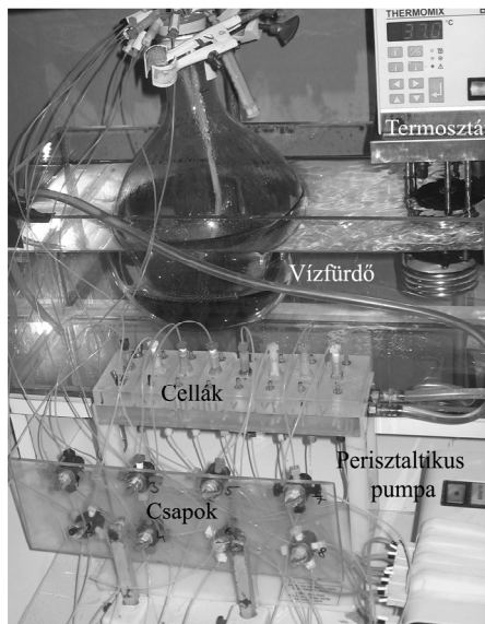
3. ábra Perifúziós rendszer (sémás rajz és fotó). A vízfürdőben tartott lombikból a médium egy négyállású csapon keresztül áramlik a cellákban található szövetmintákhoz, majd a perisztaltikus pumpán át a gyűjtőedénybe. A rajzot Matkovits Attila készítette.
