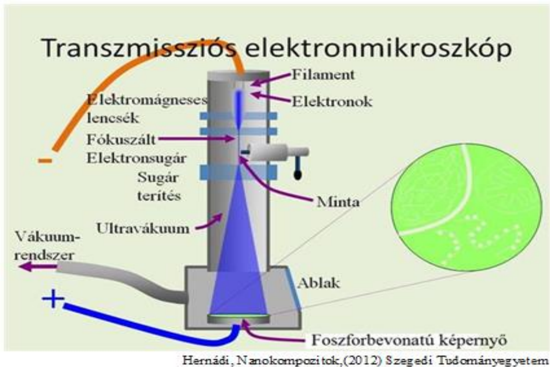
23. ábra: A transzmissziós elektronmikroszkóp (TEM) szerkezetének sematikus ábrázolása
