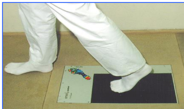
1.sz. kép.: A dinamikus talpnyomás felvétel folyamata Novel 101B EMED SF típusú érzékelő platformon, a „mid-gait” módszer bemutatása.
